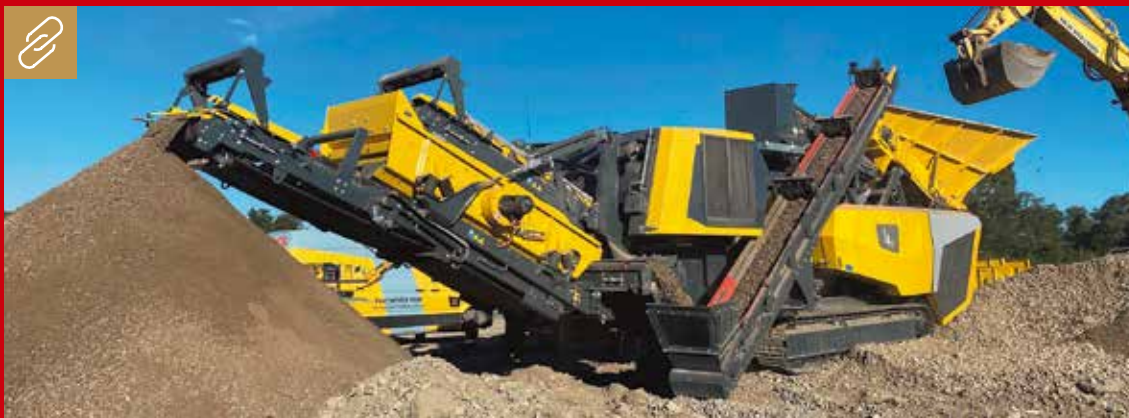
Gipo ist 2022 mit der vollelektrischen Brech- und Siebanlage P 131 GIGA auf den Markt gekommen. Sie ist mit der seit Jahren etablierten Antriebstechnologie GIPO-GREEN ausgestattet. Bild: Gipo
