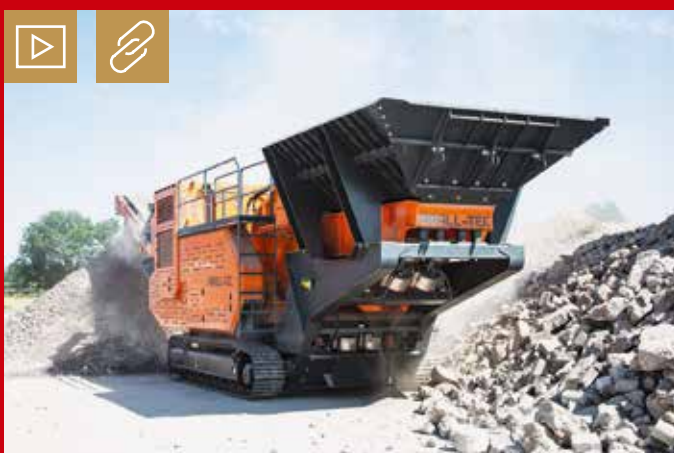
Der PT 1.1G2 von Prall-Tec ist für den Einsatz im Recycling sowie auf max. Standfestigkeit und Leistung im schweren Einsatz mit Stahlbeton, Bauschutt und anderen Aufgabematerialien ausgelegt. Bild: Prall-Tec
