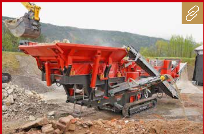
Der diesel-elektrische REMAX-450-Prallbrecher ist jetzt mit aktiver Doppeldeck-Vorabsiebung erhältlich, was den Wirkungsgrad, die Produktivität und Wirtschaftlichkeit deutlich steigert. Bild: SBM
