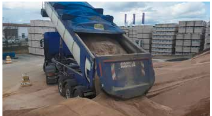
Im KS-Werk wird der sortenreine und klein gebrochene Sekundärrohstoff dem herkömmlichen Gemenge aus Sand, Kalk und Wasser beigemischt und in den Produktionsprozess gegeben.
