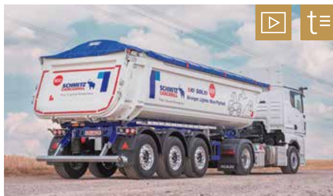
Dank neuer Mulden- und Rahmengeneration ist der neue Sattelkipper S.KI von Schmitz Cargobull bis zu 280 kg leichter. Bild: Schmitz Cargobull
