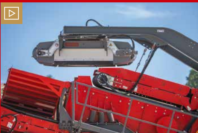
Der Eisenaustrag mit Permanentmagnet in Längsrichtung bei Gipo. Dadurch werden die Eisenteile noch besser vom Magnetabscheider erfasst, was den größtmöglichen Eisenaustrag ermöglicht. Bild: Gipo
