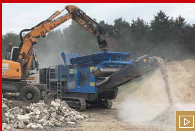
Der Aufgabetrichter des CityEquip CityTrak 9TX, der mit einer Länge von 4,6 m die Befüllung mit z.B. großen Radladern zulässt, ist großzügig dimensioniert. Bild: Christophel
