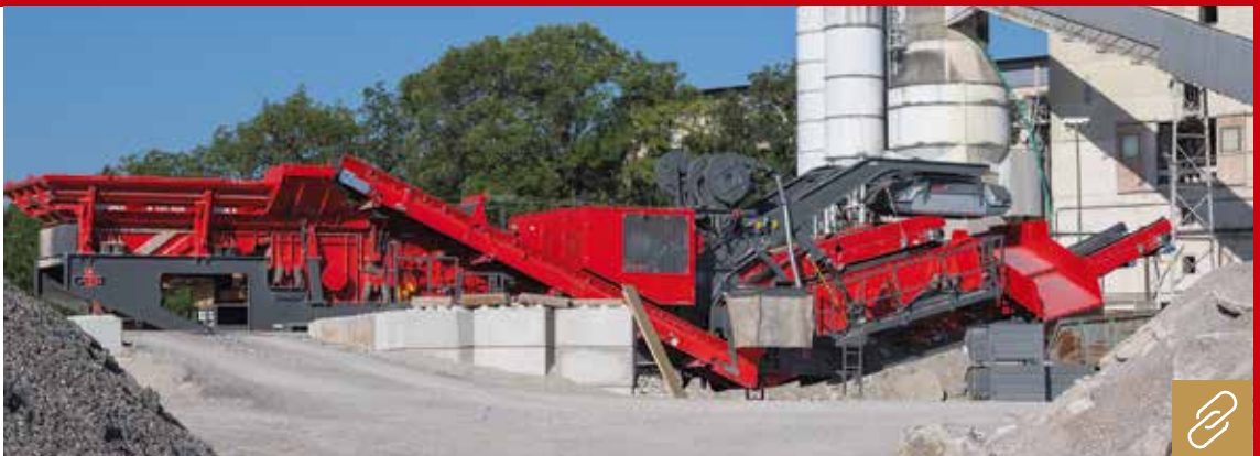
Gipo ist 2022 mit der vollelektrischen Brech- und Siebanlage P 131 GIGA auf den Markt gekommen. Sie ist mit der seit Jahren etablierten Antriebstechnologie GIPO-GREEN ausgestattet. Bild: Gipo
