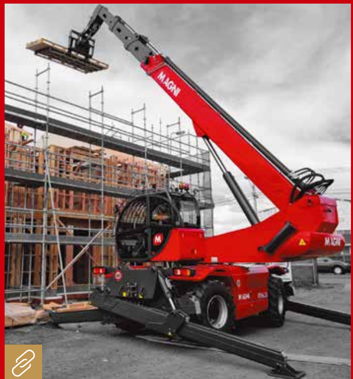
Alle Magni-Rotationsteleskopklader-Modelle (hier das Modell RTH6-25) verfügen über einen drehbaren Oberwagen, der eine 360°-Drehung ermöglicht. Bild: Magni
