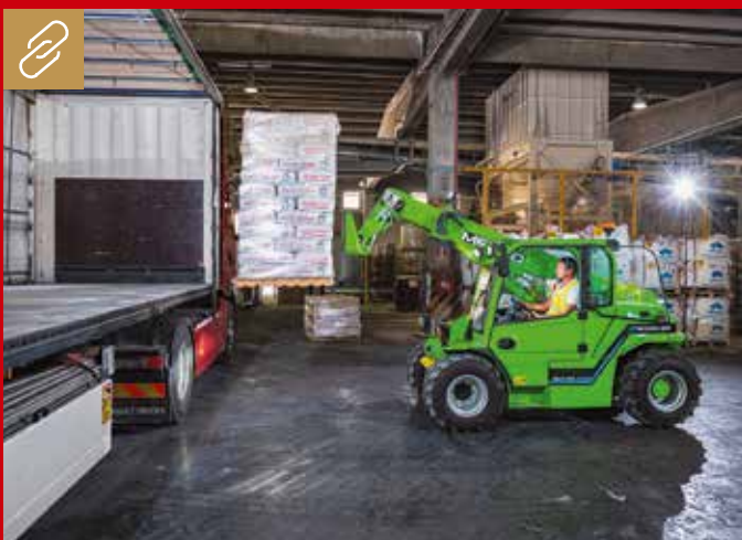
Die 48-Volt-Batterien der eWorker haben eine Ideal-Laufzeit von bis zu acht Stunden. Sie benötigen rund neun Stunden, um vollständig aufzuladen. Bild: Merlo
