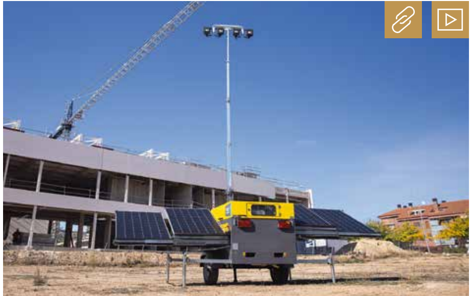
Der Lichtmast HiLight S2+ ist eine robuste Alternative zur temporären Dieselbeleuchtung für Endanwender und Mietunternehmen. Bild: Atlas Copco
