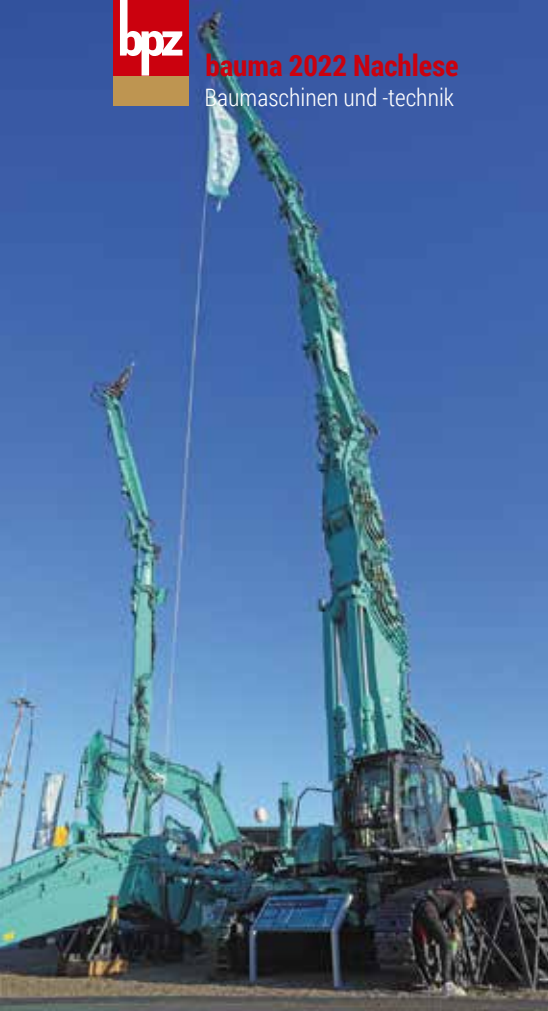
Bis zu 40 Meter Arbeitshöhe bietet der neue Kobelco SK1300DLC als größter OEM-Abbruchbagger mit Wechselausleger-Ausrüstung. Bilder: Kobelco
