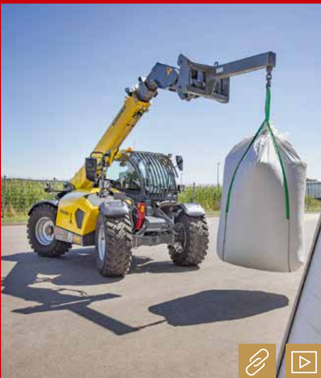
Die Teleskoplader-Serie von 3 bis 5,5 t Nutzlast von Kramer hat ein neues Motorhaubendesign erhalten, das dem Fahrer eine bestmögliche Sicht nach rechts verschafft. Bild: Modell 3610/Kramer
