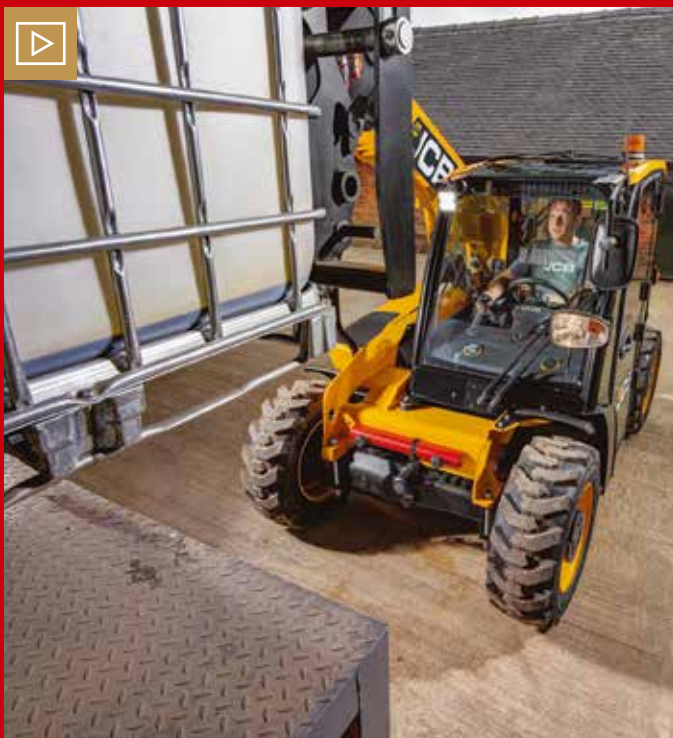
Die Fahrerkabine des 514-40 ist 20 % größer als beim Vorgängermodell 516-40 und laut JCB 200 mm breiter als bei den Modellen der Konkurrenz. Bild: JCB
