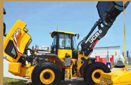
Der 457 der erste große JCB-Radlader, der die Tier-4-Final-Abgasnorm erfüllt.
