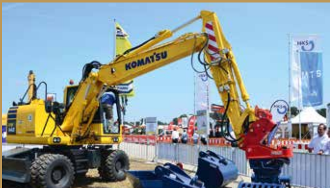
Der vollhydraulische Schnellwechsler Variolock von Lehnhoff zeigte auf der Messe sein Können.
