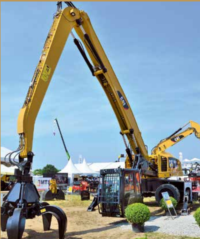
Der Cat MH3037 ist der erste einer neuen Reihe von Mobilbaggern für den Materialumschlag, die der Hersteller in der Größenklasse über 25 t einführt. Bilder: Paul Deder
