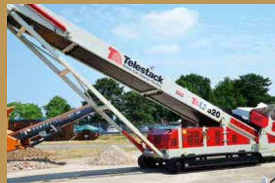
Das knapp 20 m lange Telestack LF520 übernimmt das maschinelle Aufhalten.
