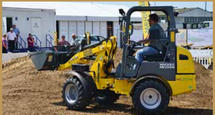
Der Radlader WL20e von Wacker Neuson wird elektrisch betrieben.
