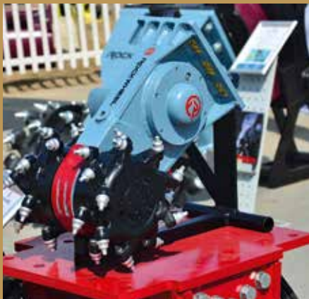
Rockwheel-Fräsen werden für Abbruch- und Lösearbeiten benutzt, als Ergänzung zu einem Löffel oder einem Hammer. Bilder: Paul Deder
