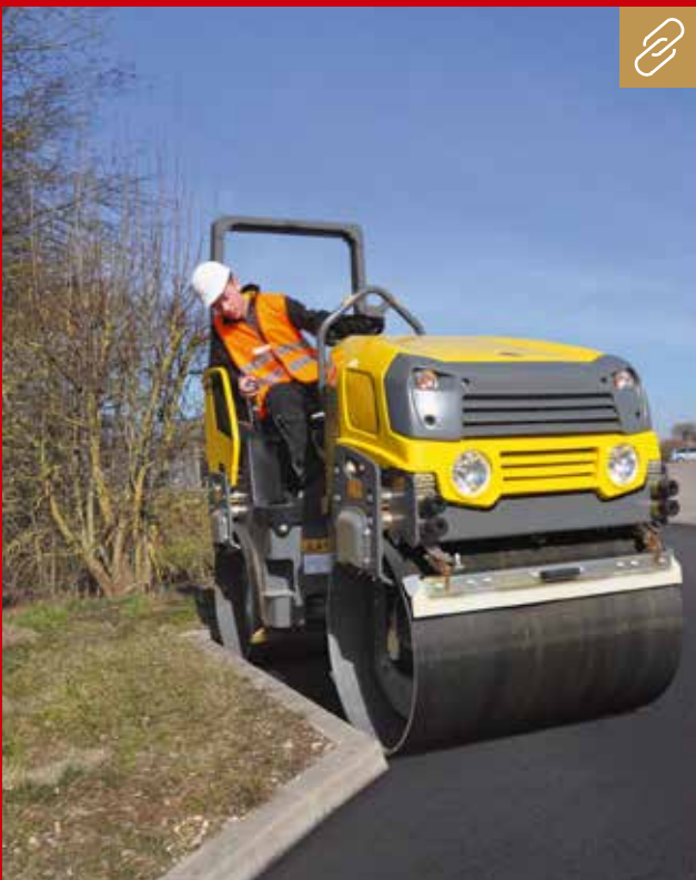
Durch die schlanke und spitz zulaufende Konstruktion der Tandemwalzen von Wacker Neuson bleibt der Blick auf die Kanten der Bandagen sowie auf das Umfeld frei. Bild: Wacker Neuson
