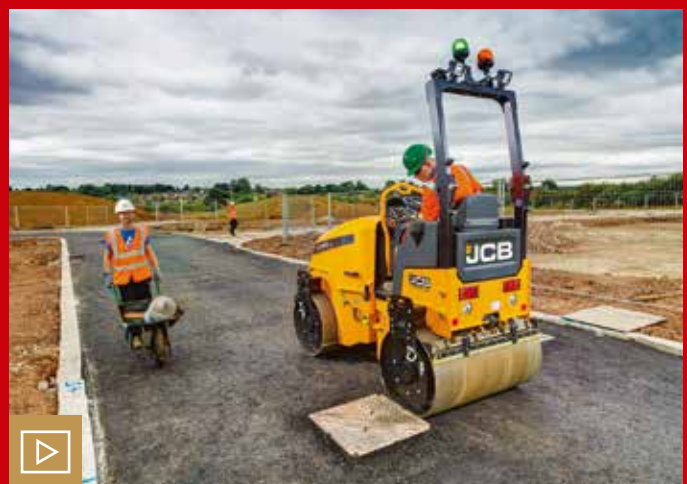
Eine einfach zu bedienende Versatzfunktion erhöht die Flexibilität der JCB-Walzen und erleichtert das Arbeiten um vorstehendes Eisenwerk und Bordsteine. Bild: JCB
