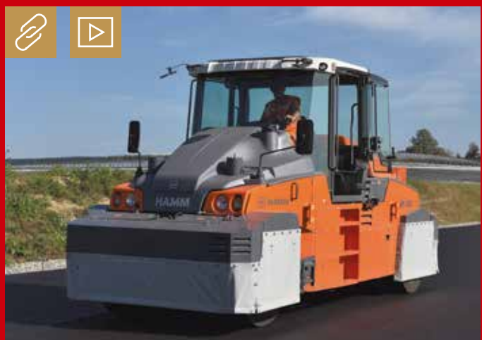
Die Hamm-Gummiradwalze HP 180i bietet hohe Verdichtungs- und Oberflächenqualität durch gleichmäßige Gewichtsverteilung und Reifenüberlappung der vorderen und hinteren Radpaare. Bild: Hamm
