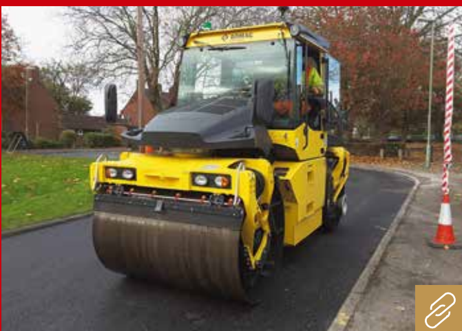
Die 9,5 t schwere Bomag-Walze BW 174 AP basiert auf einem Hydraulik-Hybrid-Antrieb. Der Hydraulikspeicher deckt kurzzeitige Lastspitzen ab, wie sie z. B. beim Einschalten der Vibration auftreten. Bild: Bomag
