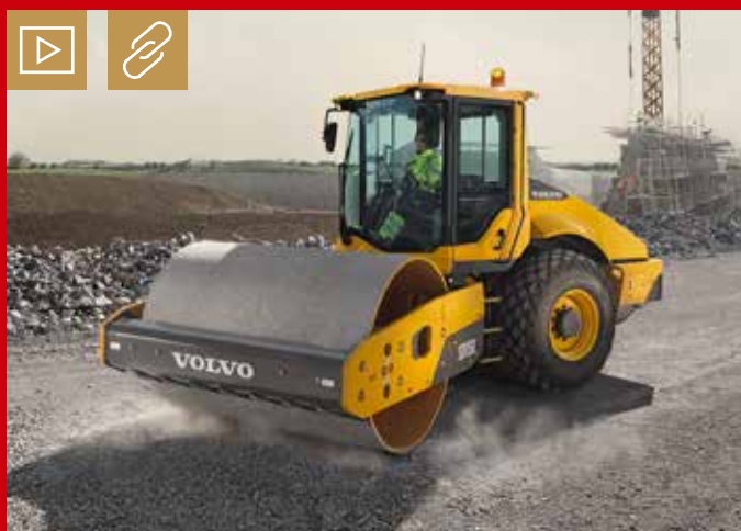
Der Eco-Modus ist bei allen Erdbauwalzen-Modellen von Volvo serienmäßig und kann durch die Anpassung der Motordrehzahl den Kraftstoffverbrauch um bis zu 40 % verringern. Bild: Volvo CE
