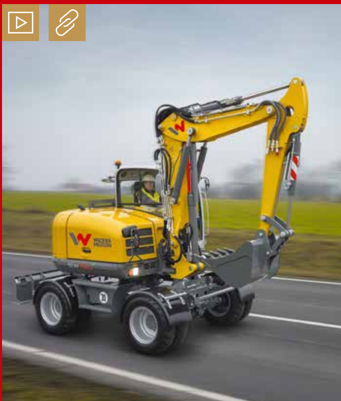
Die Mobilbagger von Wacker Neuson (im Bild der EW100) zeichnen sich durch einen stufenlosen Fahrtrieb bis zu einer Höchstgeschwindigkeit von maximal 30 km/h für schnelle Ortswechsel aus. Bild: Wacker Neuson
