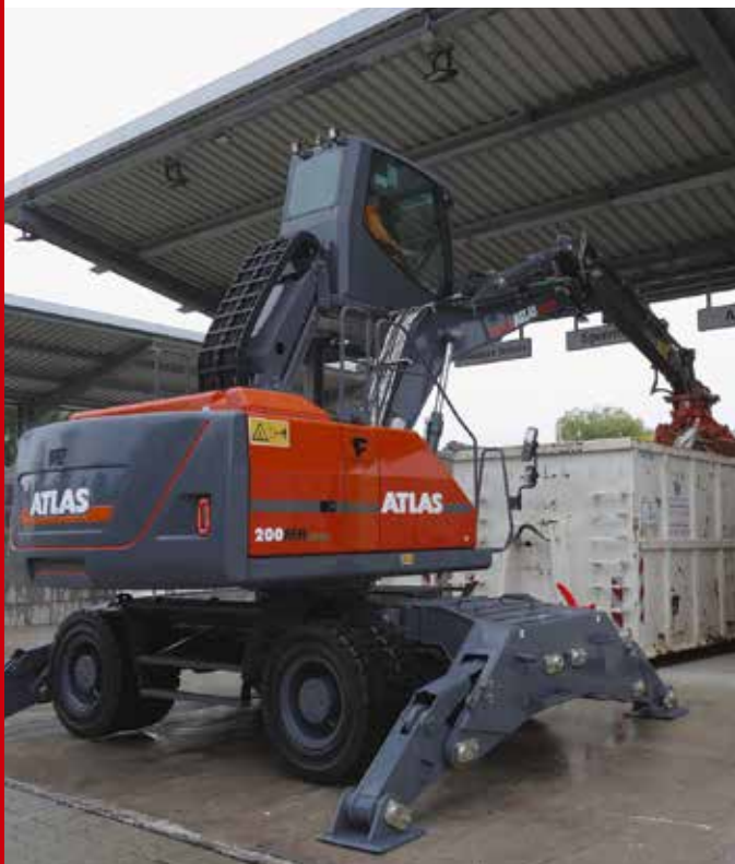
Der Akku des neuen Elektro-Umschlagbaggers 200 MH accu von Atlas reicht bei einer kontinuierlichen Nutzung bis zu vier Stunden, inklusive des Neuladens in der Mittagspause einen Arbeitstag lang. Bild: Atlas
