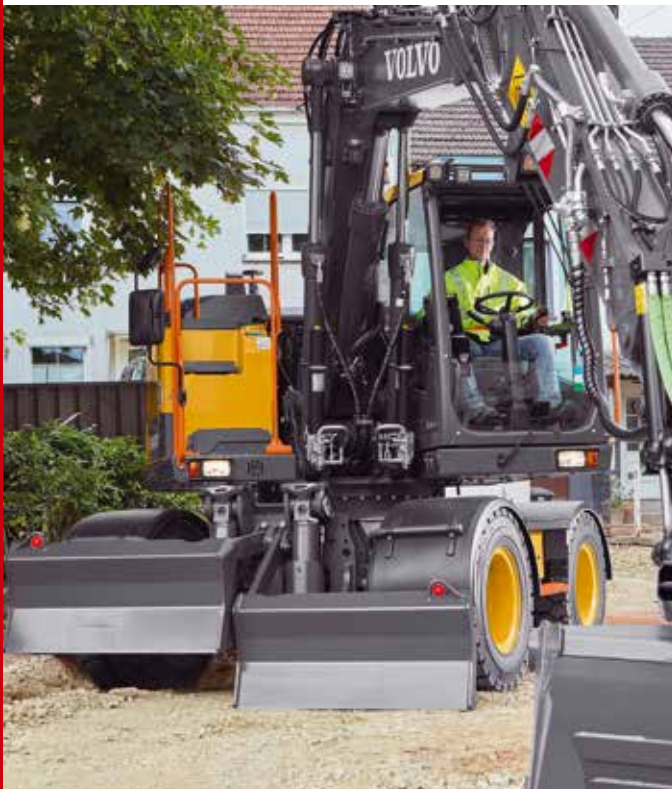
Das zweigeteilte Planierschild des EWR130E bietet noch mehr Möglichkeiten zur Nivellierung der Maschine auf unebenem Boden oder z. B. an Bordsteinkanten. Bild: Volvo CE
