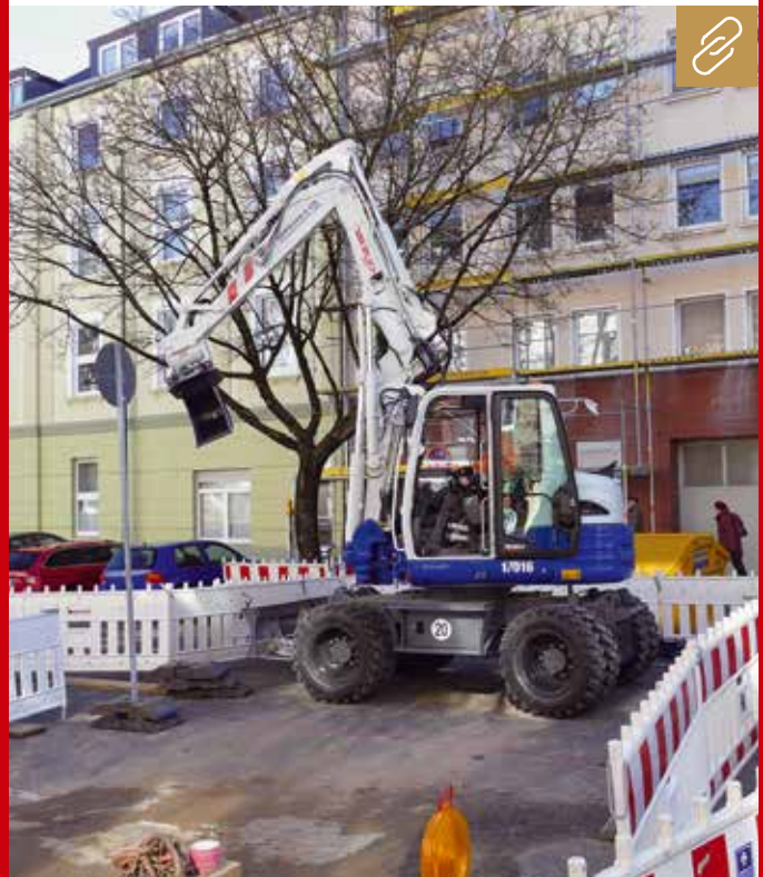
Das Modell TB 295 W-2 von Takeuchi verfügt über ein Einsatzgewicht von 10,1 t, eine Grabtiefe von 4.115 mm und eine Überladehöhe von 6.480 mm. Bild: Wilhelm Schäfer
