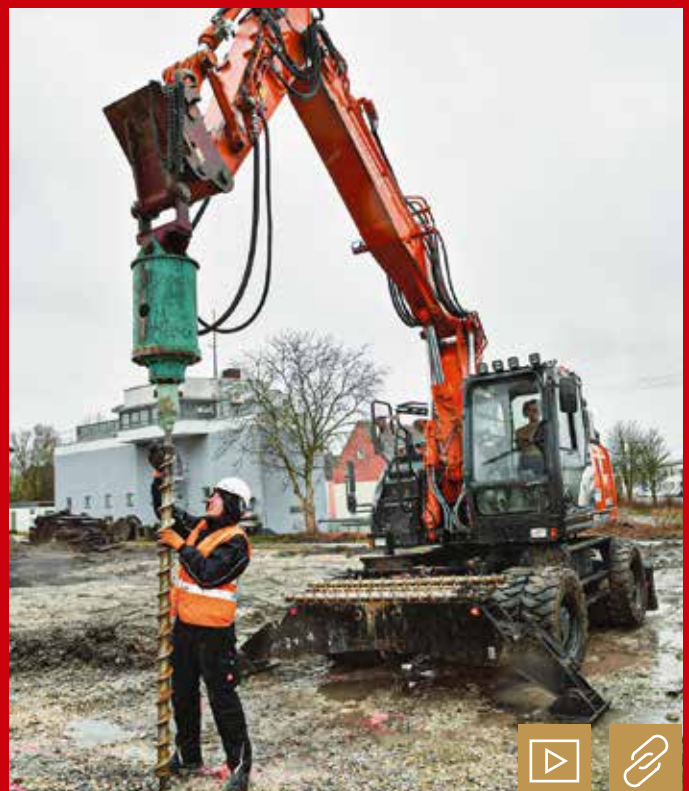
Das Werkzeug-Kontrollsystem des Hitachi Zaxis ZX190W-6 mit seinen beiden Kippmodi ermöglicht eine problemlose Aufnahme unterschiedlicher Anbaugeräte. Bild: Dieter Göllner
