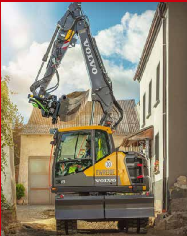
Der vordere Schwenkbereich des EWR130E weist lt. Volvo mit nur 1,81 m den kürzesten Schwenkradius in der 12- bis 13-Tonnen-Klasse auf. Bild: Volvo CE
