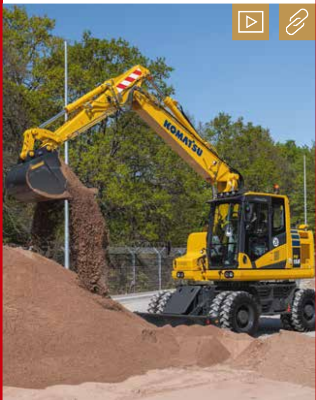
Beim Komatsu PW158-11 lassen sich bis zu 16 hydraulische Werkzeuge im Bordcomputer einprogrammieren und z. B. mit einem Schnellwechsler einfach bedienen. Bild: Komatsu
