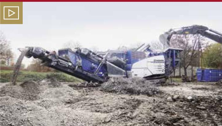
Die Prallmühle von Prall-Tec besitzt vollhydraulische Prallwerke mit 280 mm Ausweichweg und im Auslauf eine Schwingförderrinne mit Hardox-Verschleißblechen.
