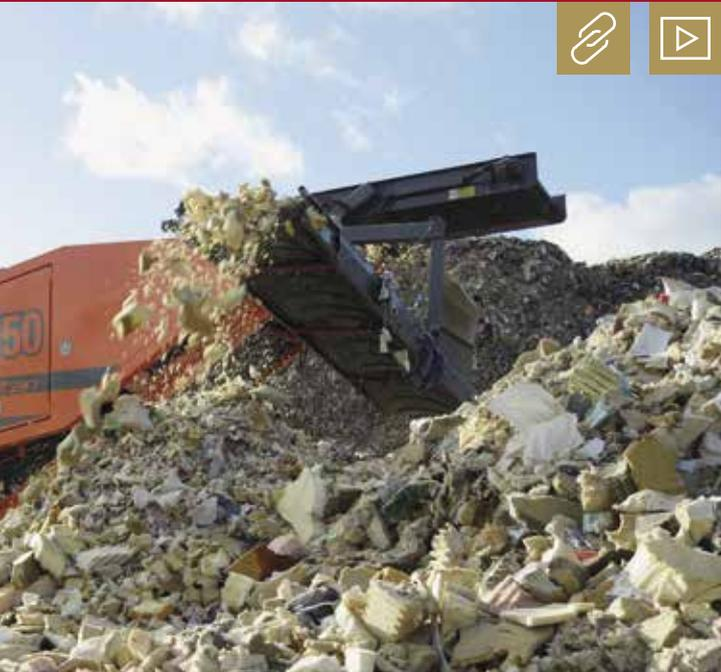
Vordefinierte Zerkleinerungsprogramme und eine hybride Steuerung ermöglichen beim Vorzerkleinerer VZ 950 TITAN von Arjes eine individuelle Anpassung des Wellenlaufs auf andere Materialarten und beeinflussen die Geschwindigkeit, den Wechsel zwischen asynchronem und synchronem Lauf sowie die Einstellung der Reversierzeiten. Bild: Arjes
