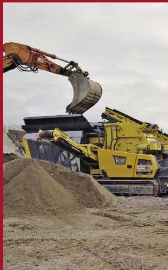
sion R3 und als „Vollhybrid“ Keestrack R3e mit diesel-elektrischem Antrieb und Plug-In-Netzversorgung.
