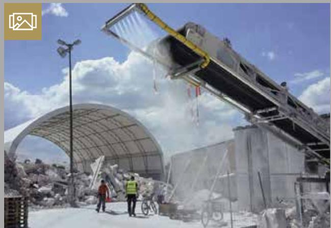
Stationäre Benebelung eines Bandabwurfs. Das System ermöglicht es, mit einem sehr geringen Wassereintrag eine Staubreduzierung von über 90 % zu erreichen. Bild: Neborex
