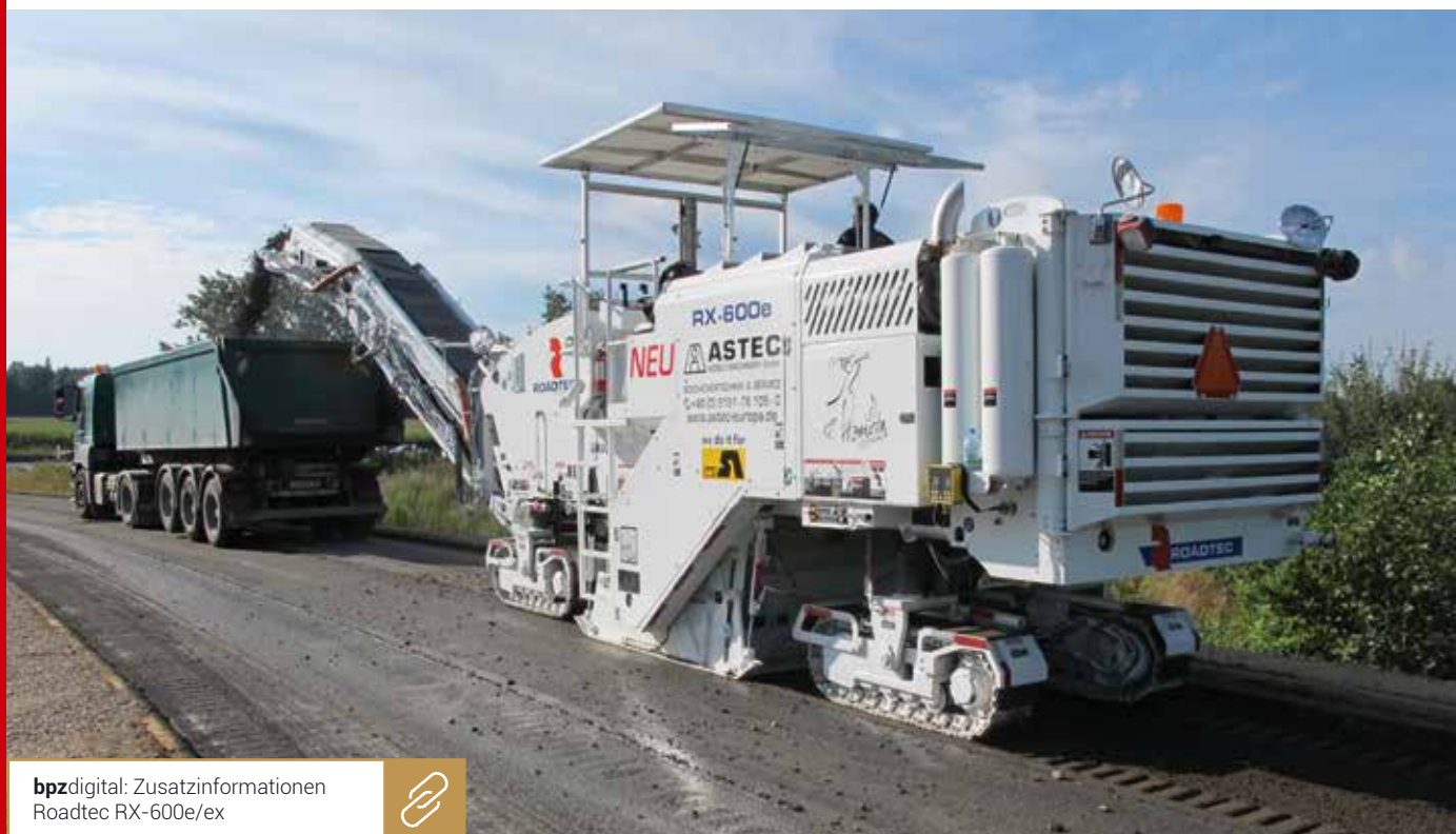
Die Roadtec RX-600e von Astec arbeitet mit Fräsbreiten von 1905, 2007 oder 2184 mm und lässt sich optional mit dem variablen Frässystem VCS (Variable Cutter System) für 610, 915 und 1220 mm Fräsbreite aufrüsten. Bild: Astec
