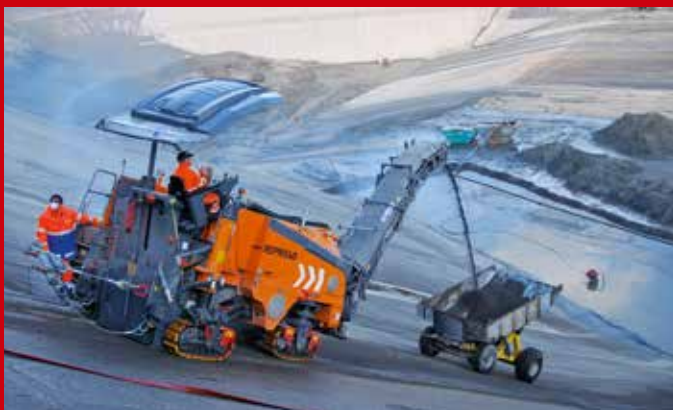
Bei der Sanierung eines Speicherbeckens glich das Bedienpult einer Wirtgen W 130 F die Neigung aus, sodass der Bediener auch im Steilhang einen ergonomischen Arbeitsplatz hatte. Bild: Wirtgen
