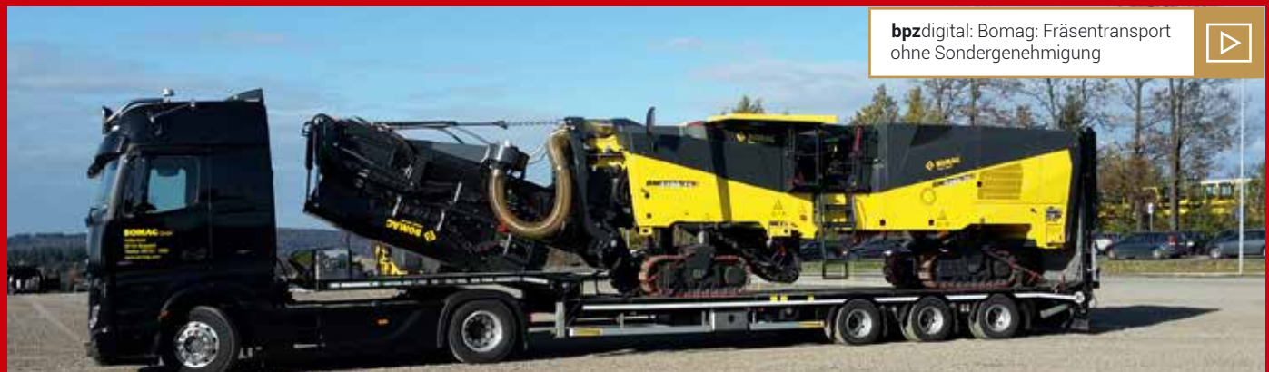
Transport ohne Sondergenehmigung: Bei Bomag können die Basismaschine und das Fräsaggregat bequem per Standard-Tieflader und Absetzkipper zur Baustelle transportiert und dort in kürzester Zeit zum Einsatz gebracht werden. Bilder: Bomag
