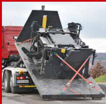
Transport ohne Sondergenehmigung: Bei Bomag können die Basismaschine und das Fräsaggregat bequem per Standard-Tieflader und Absetzkipper zur Baustelle transportiert und dort in kürzester Zeit zum Einsatz gebracht werden. Bilder: Bomag
