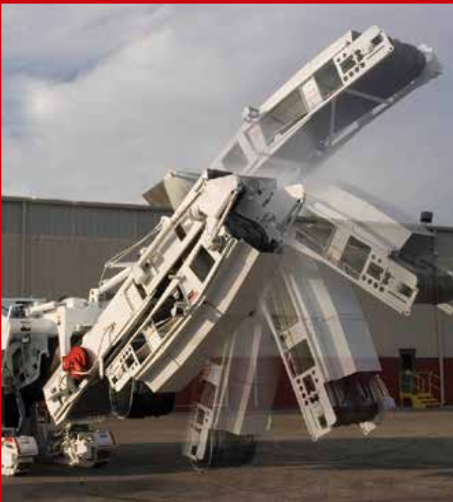
Hydraulisch einklappbare Förderbänder, als Option erhältlich, verbessern bei den größeren Roadtec-Straßenfräsen von Astec aus Hameln die Transportfähigkeit, da die Länge beträchtlich verringert wird. Bild: Astec
