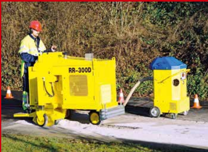
Die nur 1,8 t wiegende Roto-Runner RR 300 von Airtec für 400 mm Fräsbreite und bis zu 50 mm Frästiefe kann wahlweise von einem Diesel- oder Elektromotor angetrieben werden. Bild links: Airtec
