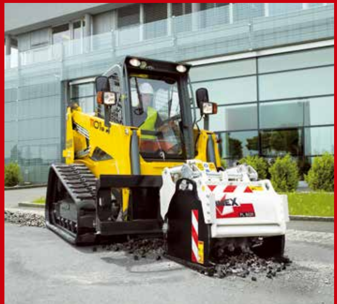
Die nur 1,8 t wiegende Roto-Runner RR 300 von Airtec für 400 mm Fräsbreite und bis zu 50 mm Frästiefe kann wahlweise von einem Diesel- oder Elektromotor angetrieben werden. Bild links: Airtec
