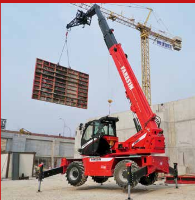
Mit ausgefahrenen Abstützungen nimmt der Merlo Roto 40.25 MCSS für bis zu 4 t Tragkraft knapp 5 m Breite ein und lässt sich so wie ein Turmkran oder eine Hubbühne auch in engen Bereichen nutzen.
