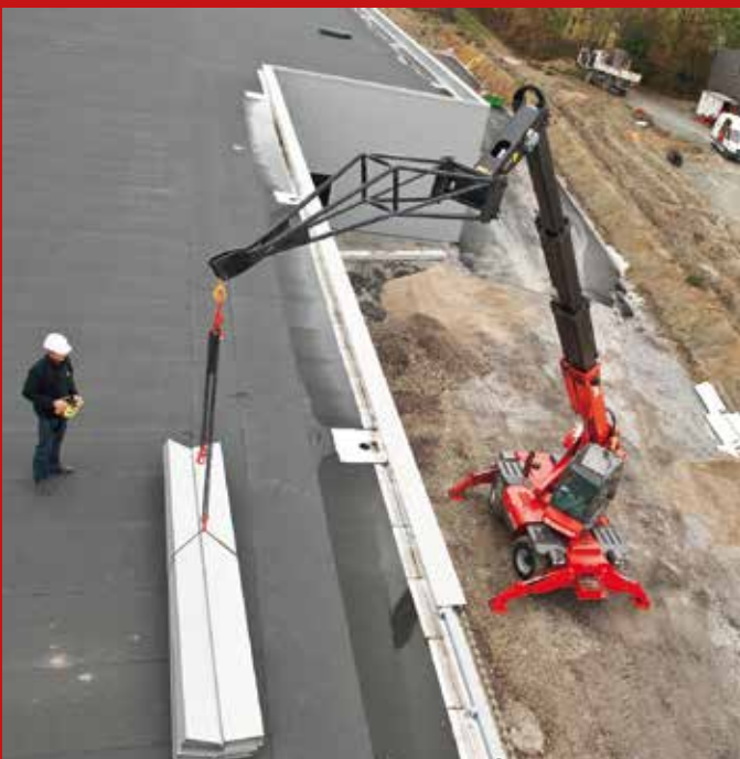
Beim neuen Merlo Roto 45.35 für 35 m Hubhöhe erlaubt ein Hybridantrieb mit 400-V-Kabelzuführung den abgasfreien und leisen elektrischen Betrieb von Oberwagen, Teleskoparm und Anbaugeräten.
