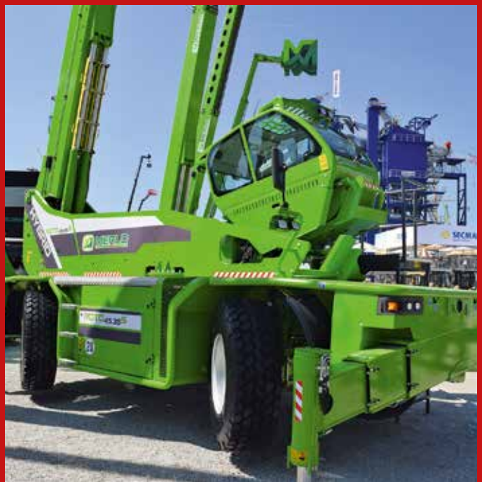
Beim neuen Merlo Roto 45.35 für 35 m Hubhöhe erlaubt ein Hybridantrieb mit 400-V-Kabelzuführung den abgasfreien und leisen elektrischen Betrieb von Oberwagen, Teleskoparm und Anbaugeräten.
