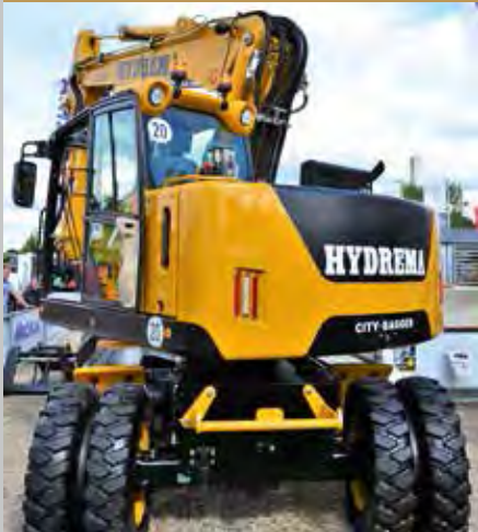
Der City-Bagger mit dem kleinen Schwenkradius ist für die Stadtbaustelle gut gerüstet.
