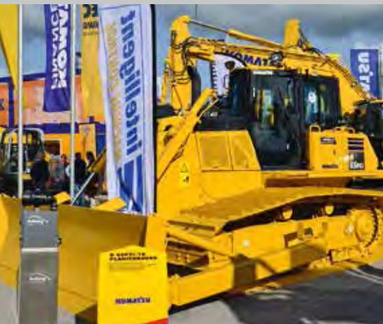
Die auf der Intermat erstmals vorgestellte Planierraupe D65EXi/PXi-18 ist mit der intelligenten Maschinensteuerung ausgerüstet.
