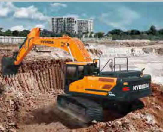
Beim HX300-Raupenbagger entschied sich Hyundai für eine kombinierte Lösung aus AGR, Katalysator und SCR. Bild: Hyundai
