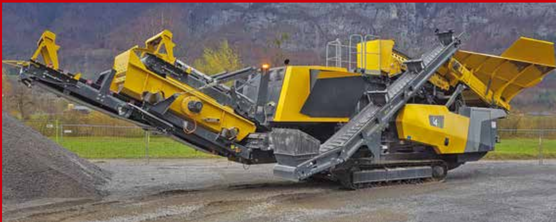
Dank der innovativen RIC-Brechertechnologie (Reversible Impact Crusher) lässt sich die raupenmobile Prallmühle Keestrack I4e sehr flexibel in der Nachzerkleinerung von Gestein und Recycling-Baustoffen (z. B. Asphalt, Schlacke) einsetzen. Bild: Keestrack
