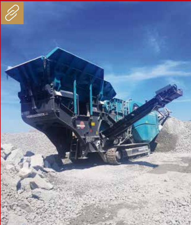
Ein Zwei-Deck-Schwerlastvorsieb in Verbindung mit einem XL-Hopper gewährleistet hohen Durchsatz und Produktivität und verringert den Verschleiß beim Backenbrecher Powerscreen PT600E-XL. Bild: Jürgen Kölsch
