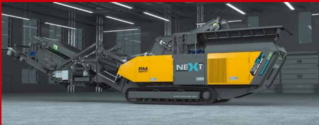
Dank der innovativen RIC-Brechertechnologie (Reversible Impact Crusher) lässt sich die raupenmobile Prallmühle Keestrack I4e sehr flexibel in der Nachzerkleinerung von Gestein und Recycling-Baustoffen (z. B. Asphalt, Schlacke) einsetzen. Bild: Keestrack
