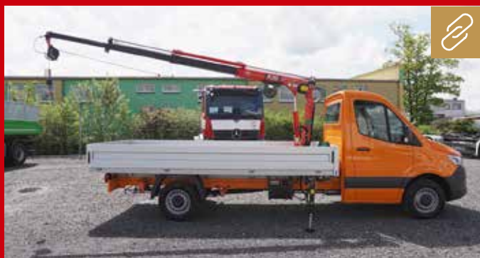
Den Maxilift 270 von Next Hydraulics gibt es mit zwei verschiedenen Armsystemen – mit einer Reichweite von bis zu 5 m. Bild: De Bondt
