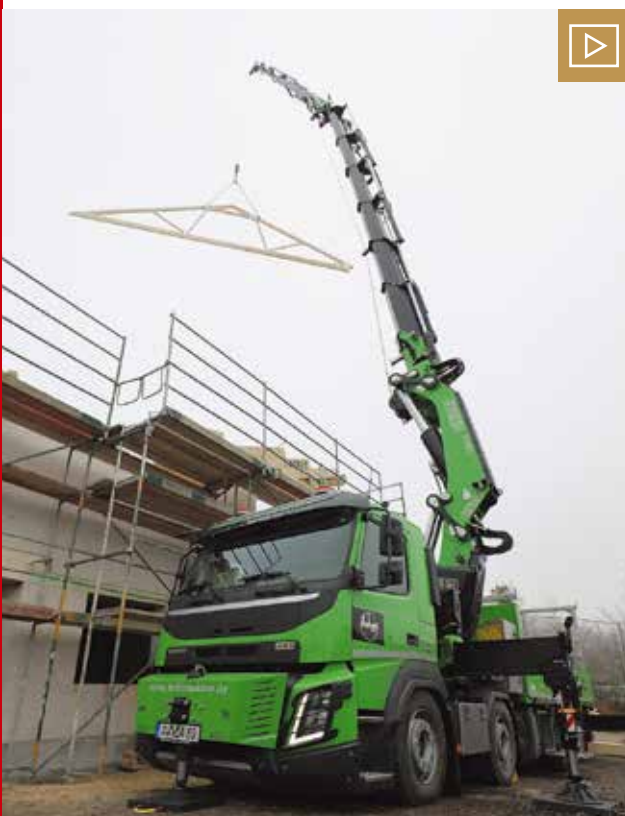
Die Ladekran-Modelle der schweren Baureihe von Fassi (hier das Modell F1150) sind für die Montage auf Lkws auf drei oder vier Achsen konzipiert. Bild: Fassi
