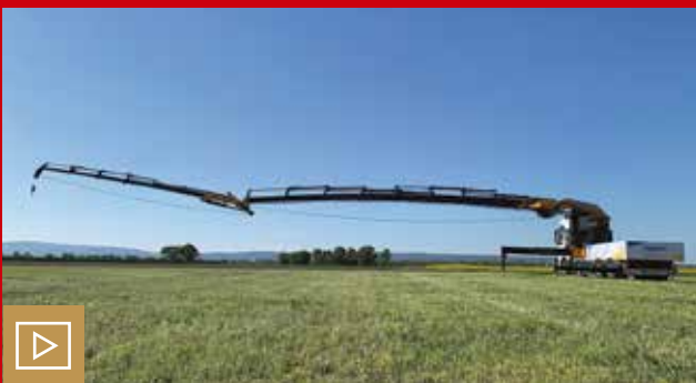
Der Knickarm des Effer 1405 kann um 15°, der Jib sogar um 20° überstreckt werden. Bild: Effer
