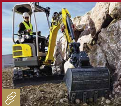
Bis zu vier Zusatzsteuerkreise sorgen beim Zero-Tail-Bagger EZ17 von Wacker Neuson für den einfachen Betrieb von Anbauwerkzeugen. Bild: Wacker Neuson
