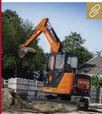
Der Motor des ZX65USB-6 ist zur Reduzierung von NOx und Feinstaub mit AGR und DPF ausgestattet. Bild: Hitachi
