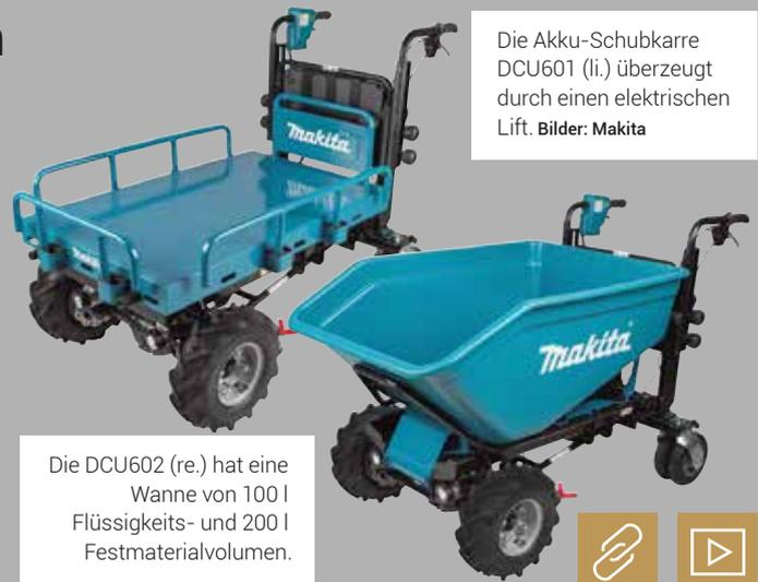
Die Akku-Schubkarre DCU601 (li.) überzeugt durch einen elektrischen Lift. Bilder: Makita
