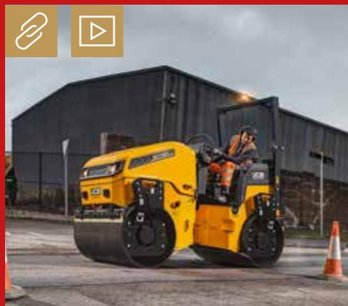
Die JCB-Tandemwalzen CT380-130 und CT430-130 werden von dem neuesten EU-Stufe-V-JCB von Kohler Dieselmotor angetrieben, der 36,5 kW leistet. Bild: JCB
