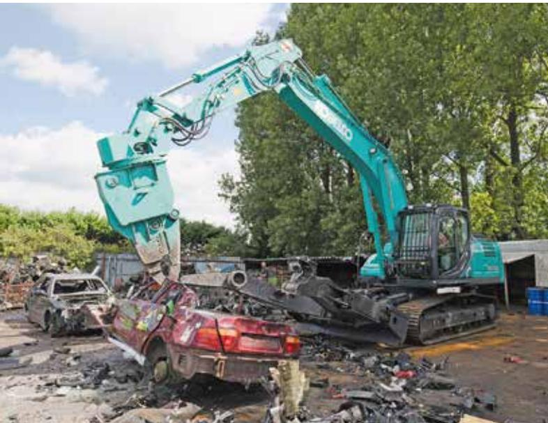
Die Multi-Demontagebagger von Kobelco (im Bild der SK210D) sind Experten in der Altfahrzeug-Verwertung. Bild: Kobelco
