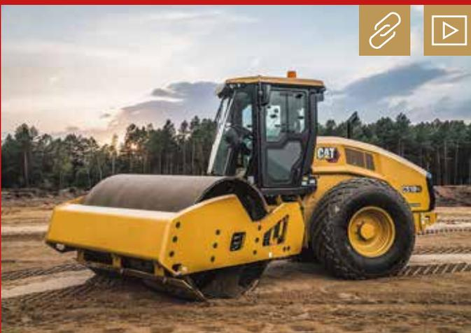
Mit mehr Gewicht auf der Bandage als bei den Vorgängern der B-Serie bieten die neuen Cat-Modelle der GC-Serie eine hohe Verdichtungsleistung. Bild: Zeppelin/CAT
