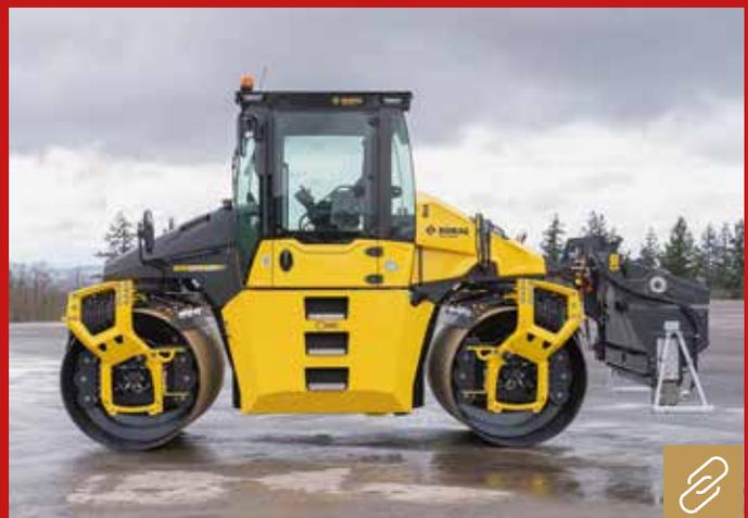
Als Verdichtungssysteme für die Tandemwalzen BW 154 und BW 174 stehen drei Technologien zur Verfügung: Asphalt Manager 2, Vibration oder TanGO4 (Oszillation mit geteilten Bandagen). Bild: Bomag
