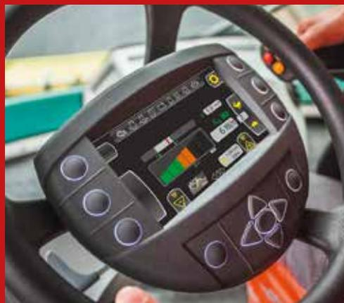
Das Display ist beim ARS 110 in der Mitte des Lenkrads angeordnet. Der Fahrer kann während der Arbeit alle wichtigen Daten leicht im Blick behalten.
