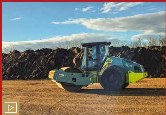
Beim ARS 110 setzt Ammann auf Radnabenmotoren anstelle einer Hinterachse. Durch die kurzen Übertragungswege vom Motor zum Rad geht damit nur wenig Leistung verloren. Bild: Ammann
