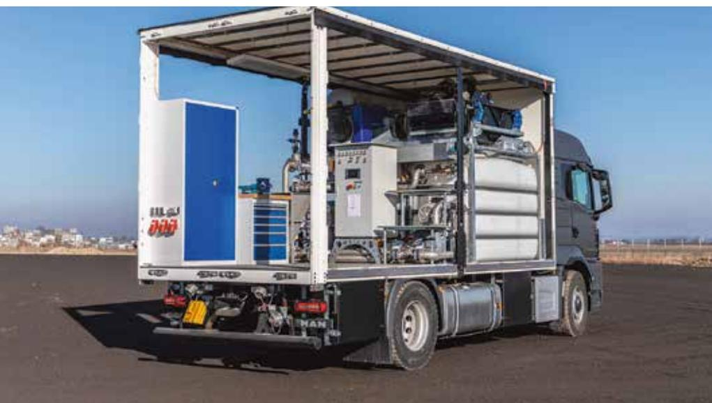
Die Recycling-Technologie Mudcleaner Truck arbeitet Bohrschlämme aus dem HDD-Verfahren sowie aus Geothermie-Bohrungen auf. Bild: Max Wild
