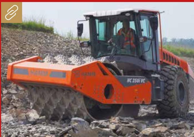
Der HC 250i C VC ist in der Lage, Mischböden, Gesteinsarten wie z. B. Basalt, Granit oder andere Baustoffe mit vergleichbarer Druckfestigkeit in einem Arbeitsgang zu brechen und zu verdichten. Bild: Wirtgen Group
