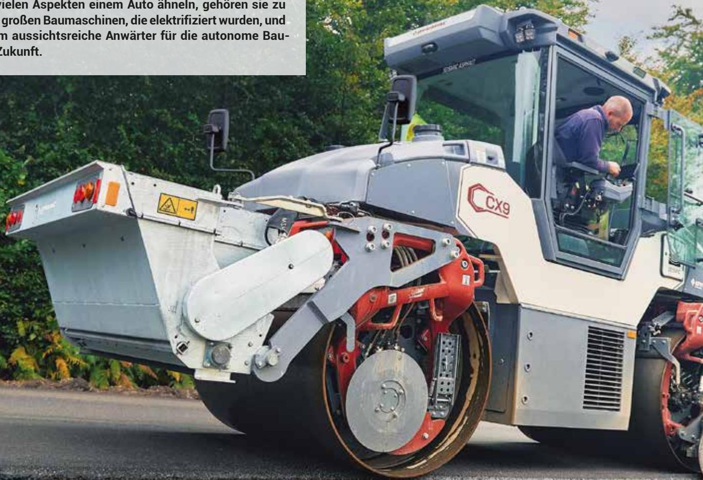
Dynapac bringt mit Seismic Asphalt eine Technologie für eine Reihe seiner Tandemwalzen (im Bild Modell CX9) auf den Markt, die die Asphaltverdichtung wesentlich effizienter machen soll. Bild: Dynapac
