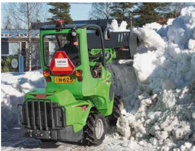
Der e527 hat eine Batteriekapazität von 27 kWh. Das ermöglicht eine Betriebszeit von ca. 6 Stunden. So kann der Lader mit einer Ladung ca. 21 km weit bewegt werden. Bilder: Paul Deder
