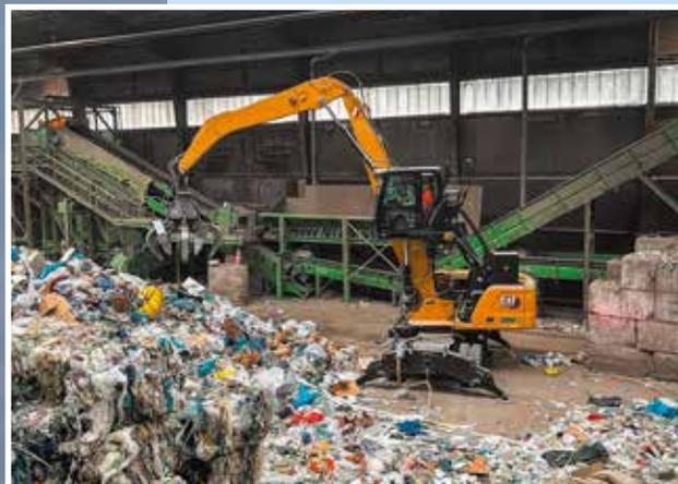
Der MH3022 Elektro wird über eine Kabeltrommel mit Starkstrom versorgt und ermöglicht CO<sub>2</sub>-Einsparungen im Materialumschlag.
