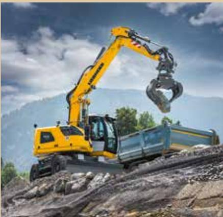
Der A 914 Compact mit vollautomatischem Schnellwechselsystem bietet durch den kurzen Heckschwenkradius erweiterte Einsatzmöglichkeiten.
