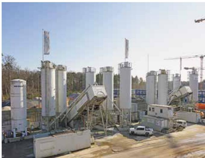
Als kombinierte Doppelanlage arbeiten seit Mai 2018 zwei EUROMIX 3000 und 3300 im Bereich Nord mit dem Beschleunigertunnel, der technischen Infrastruktur sowie über- und unterirdischen Bauten.
