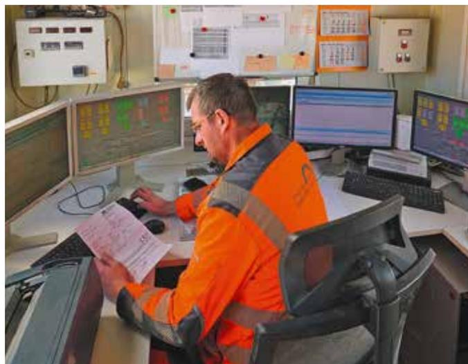
Nebeneinander positioniert verfügt das Anlagen-Duo über einen zentralen Steuerstand im Ein-Mann-Betrieb. Gemeinsam erreichen die Anlagen einen max. Festbeton-Ausstoß von 275 m<sup>3</sup>/h. **Bilder: SBM**
