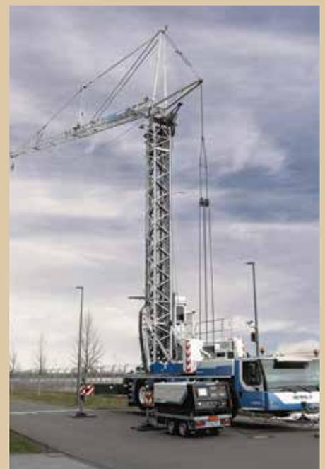
Ergänzen sich optimal: Mobiler batteriebasierter Energiespeicher Liduro Power Port (LPO) und ein Mobilbaukran.
