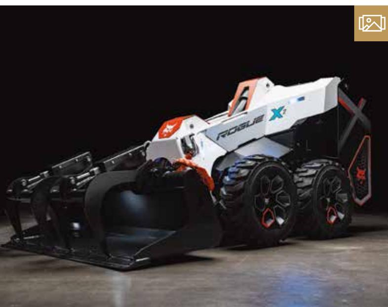
RogueX2 ist eine vollelektrische und autonome Konzeptmaschine. Der Lader ist mit Rädern anstelle von Raupen ausgestattet, um die Betriebszeit der elektrischen Batterie zu optimieren. Bild: Bobcat
