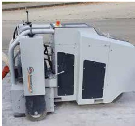
Die BEF 400RC ermöglicht das barrierefreie Einebnen von gepflasterten Wegen, Straßen und Plätzen. **Bilder: Schwamborn**
