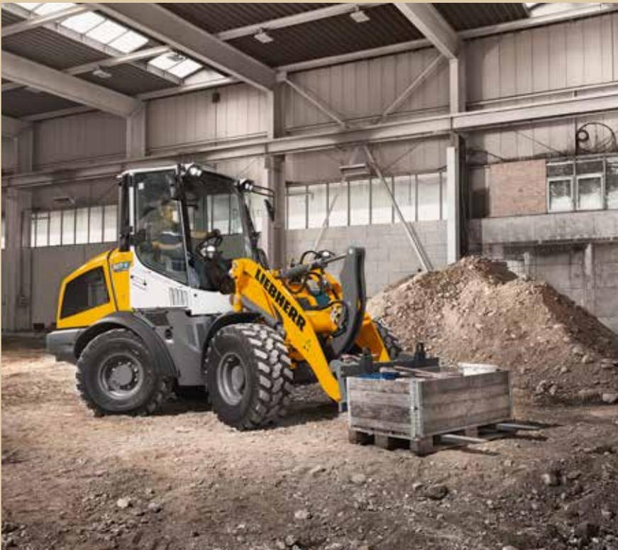
Lokal kein CO<sub>2</sub>-Ausstoß: Der L 507 E eignet sich auch für Halleneinsätze, ist dabei bei der Leistungsfähigkeit identisch mit herkömmlich angetriebenen Liebherr-Radladern derselben Größenklasse. **Bilder: Liebherr**
