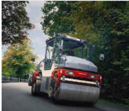
Im Rahmen der Sanierung einer Ortsdurchfahrt erhielt der langjährige Service- und Vertriebspartner von Dynapac, Michael Westphal Baumaschinen aus Eckernförde, die Möglichkeit, die moderne Walze CX9 erstmals in Deutschland einzusetzen. Die Maschine ist mit dem automatischen SEISMIC Asphalt Verdichtungssystem ausgestattet und wurde einem ausführlichen Praxistest unterzogen. 40
