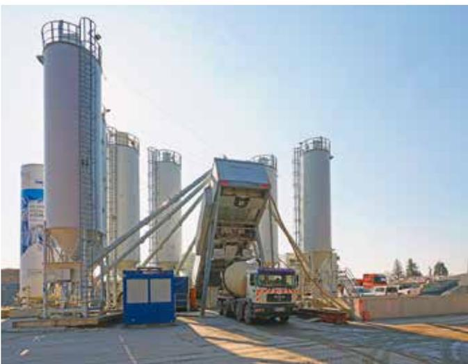
Bis auf das befahrbare Restbeton-Recyclingbecken erforderte die kompakte EUROMIX 4000 auch für den langfristigen FAIR-Einsatz keine aufwendige bauseitige Vorbereitung.
