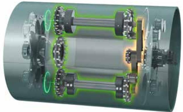
Die neue Tandemwalze HD+ 120i V-VIO von Hamm ermöglicht dank ihrer VIO-Bandage hohe Einsatzflexibilität und ist gut geeignet zur Verdichtung neuer Asphaltmischgüter. **Bilder: Hamm**
