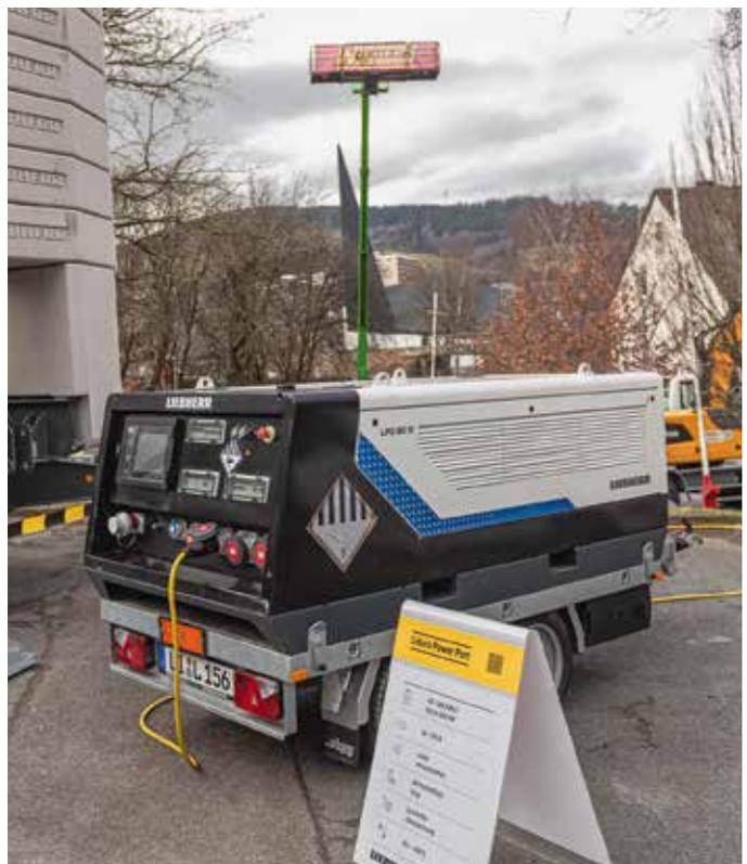
Im Außenbereich zeigte VDBUM-Schwerpunktpartner Liebherr seinen mobilen Energiespeicher. Der Liduro Power Port ist eine integrierte oder autarke Stromquelle für Elektrofahrzeuge und Maschinen auf Baustellen mit begrenzter oder ohne Netzversorgung. Bild: Paul Deder
