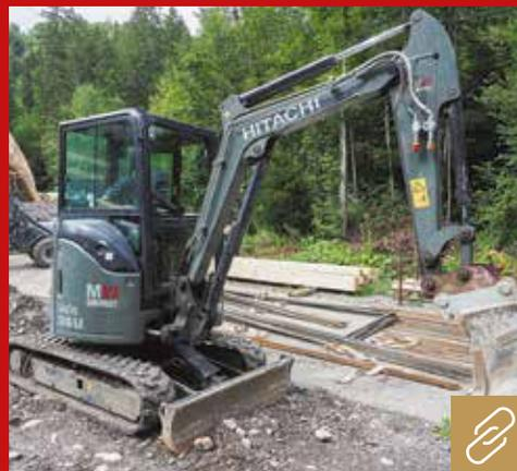
Der Hitachi ZX26U lässt sich bequem auf einem 3,5-Tonnen-Anhänger mit Löffel und Schnellwechsler von einer Baustelle zur anderen transportieren.
