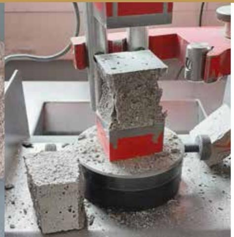
Getemperter und gemahlener Ton für den Ersatz von Klinkern im Zement (Bild links). Normenprüfung der Biegezug- und Druckfestigkeiten (Bild rechts). **Bilder: Rohrdorfer**
