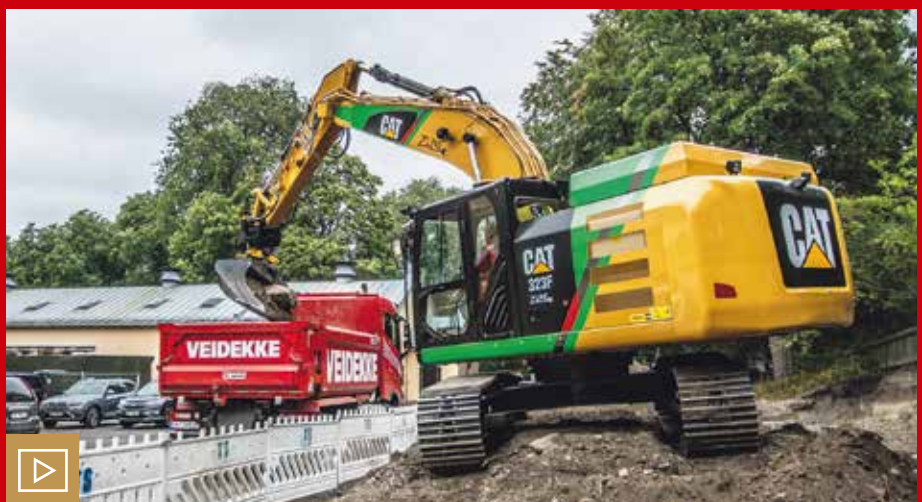
Statt Dieselmotor und Tank sind beim Kettenbagger 323F ZLine von Cat ein Elektromotor, ein Batteriemodul mit 296 kWh, ein integriertes Ladegerät und verschiedene Steuergeräte verbaut. Bild: Zeppelin
