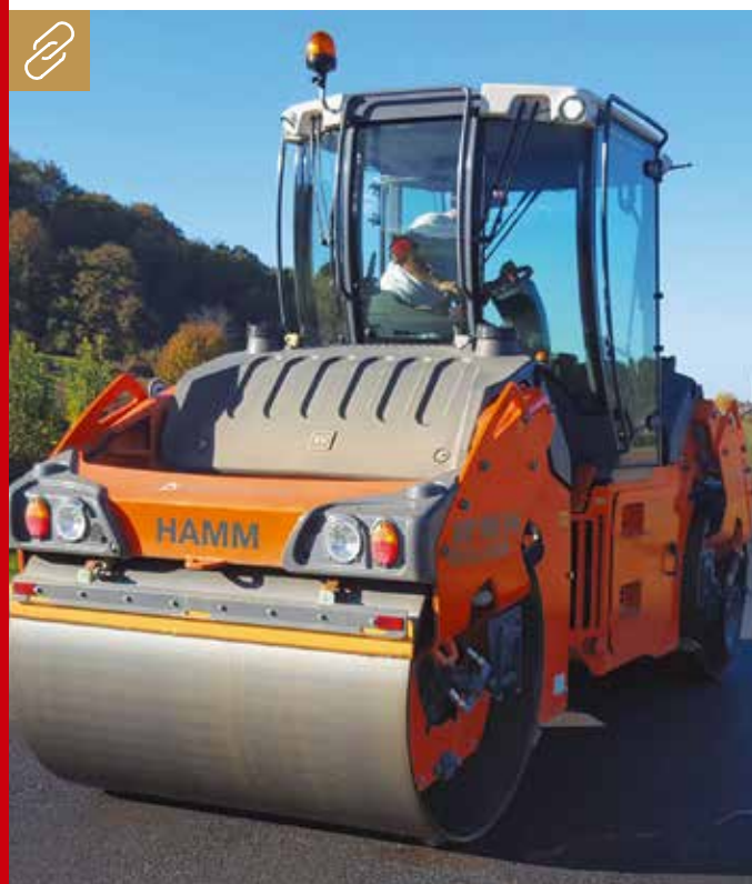
Die Hybrid-Tandemwalze HD+ 90i PH von Hamm zeichnet sich durch geringere Geräuschemissionen, reduzierte CO 2 -Emissionen und einen bis zu 15 % niedrigeren Kraftstoffverbrauch aus. Bild: Hamm
