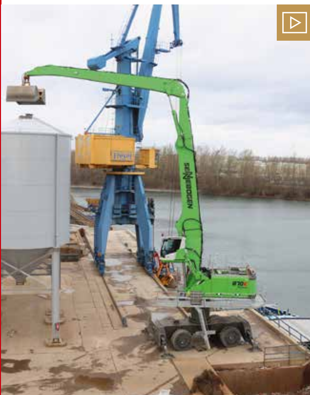
Je nach Maschinentyp (im Bild Umschlagbagger 870) können dank des Green Hybrid Systems Energieeinsparungen von Sennebogen zwischen 35 und 55 % erreicht werden. Bild: Sennebogen
