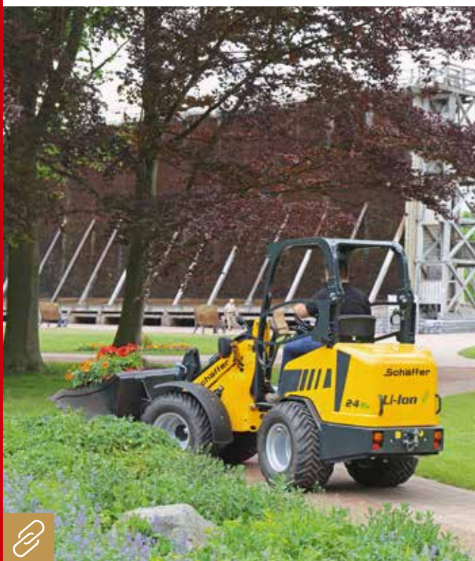
Schäffer bietet für den 24e serienmäßig ein On-Board-Ladegerät an, das mit einem 230 V-Stromanschluss betrieben wird. Schneller geht es mit einem externen Ladegerät mit 400-V-Eingangsspannung. Bild: Schäffer
