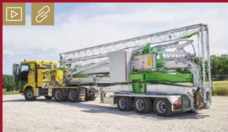
Der Europrint DS 318 erlangt durch die hydraulischen Klappballaste eine optimale Sattelast für den sicheren Straßentransport mit 80 km/h.
