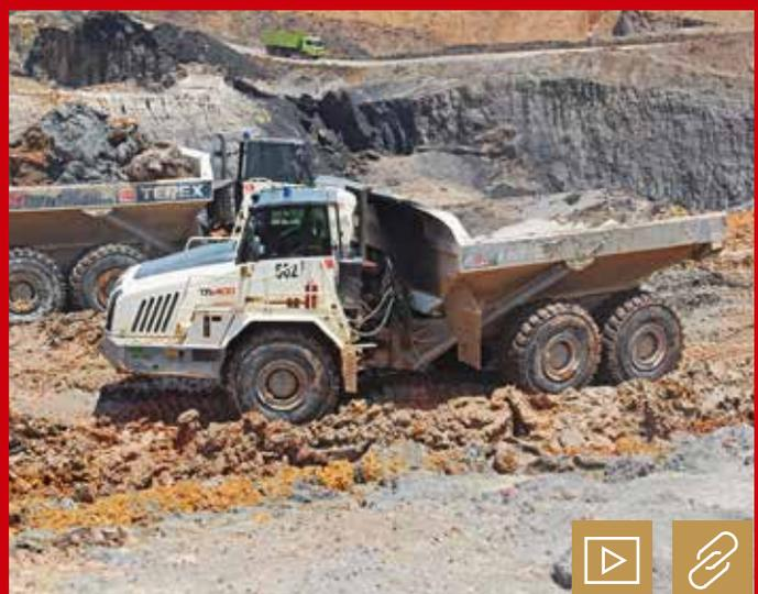
Der Terex TA400 mit seinen 41,9 t Nutzlast wurde konzipiert, um extremen Bedingungen auf großen Bauprojekten, Steinbrüchen und Minengeländen – hier im Kohletagebau – zu trotzen.
