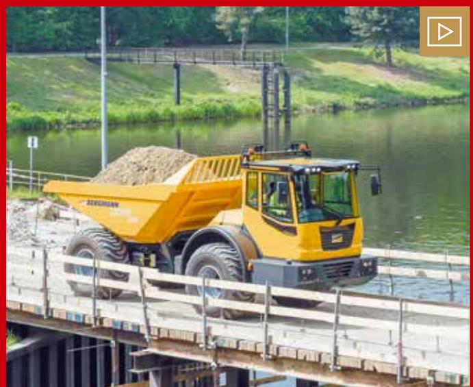
Der 119 kW starke Bergmann 3012 fährt vorwärts bis zu 40 km/h schnell, während das Knickpendelgelenk mit einem Winkel von 37° engste Kurvenradien ermöglicht. Bild: Bergmann
