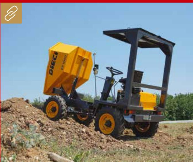
Das Modell 1000 F von Dieci wartet mit einem hydraulischen Frontkipper auf, während der 1000 T nach allen drei Seiten kippt und der 1000 PA über eine hydraulisch betriebene Ladeschaufel verfügt. Bild: Dieci
