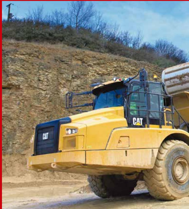
während des Fahrtrichtungswechsels: Beim Umschalten des Getriebes von Vorwärts auf Rückwärts (oder umgekehrt) wird der Muldenkipper bis zum Stillstand abgebremst, ehe er sich in die entgegengesetzte Richtung bewegen kann.
