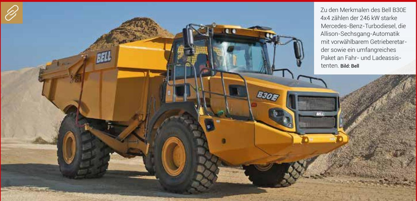
Zu den Merkmalen des Bell B30E 4x4 zählen der 246 kW starke Mercedes-Benz-Turbodiesel, die Allison-Sechsgang-Automatik mit vorwählbarem Getrieberetar der sowie ein umfangreiches Paket an Fahr- und Ladeassistenten. Bild: Bell
