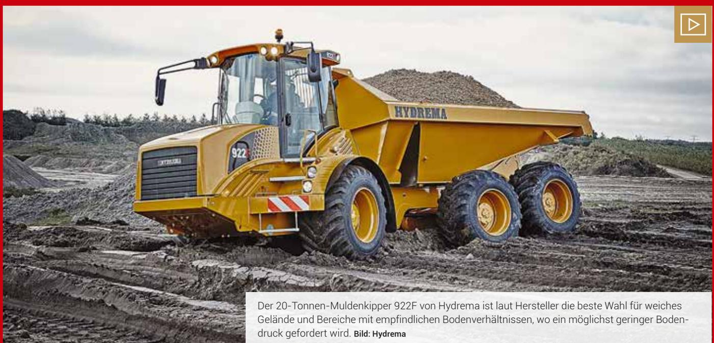
Der 20-Tonnen-Muldenkipper 922F von Hydrema ist laut Hersteller die beste Wahl für weiches Gelände und Bereiche mit empfindlichen Bodenverhältnissen, wo ein möglichst geringer Bodendruck gefordert wird. **Bild: Hydrema**
