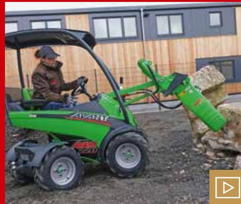
Ein nur 99,5 cm breiter und 700 kg schwerer Avant 220 mit pffiger Knicklenkung zerkleinert mit dem Hydraulikhammer Betonreste.
