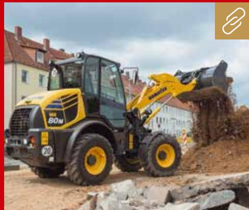
Beim Staplereinsatz Parallelhub dank neuer EF-Kinematik und eine Pendelhinterachse für hohen Fahrerkomfort bietet der Komatsu WA80M-7.
