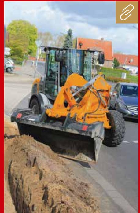
Schwenklader wie der Paus SL 7.7 beanspruchen nur eine Fahrspur und ersparen bei vielen Arbeiten unzählige Rangiermanöver, hier beim raschen Verfüllen eines Grabens. **Bild: Paus**
