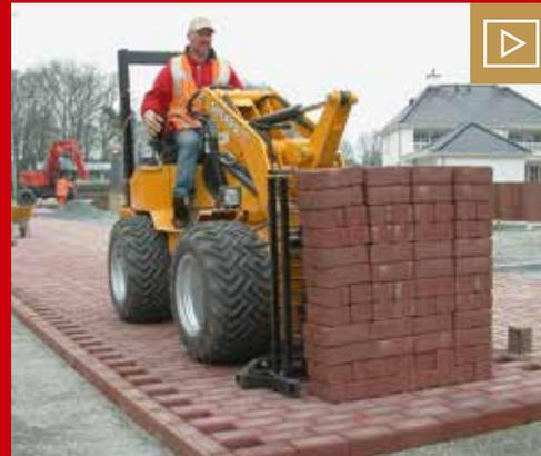
Der Sherpa 300 ist mit 25 kW (34 PS) der stärkste Knicklader von Hanenberg, hier mit Steinklammer und Niederdruckbereifung für geringen Bodendruck.
