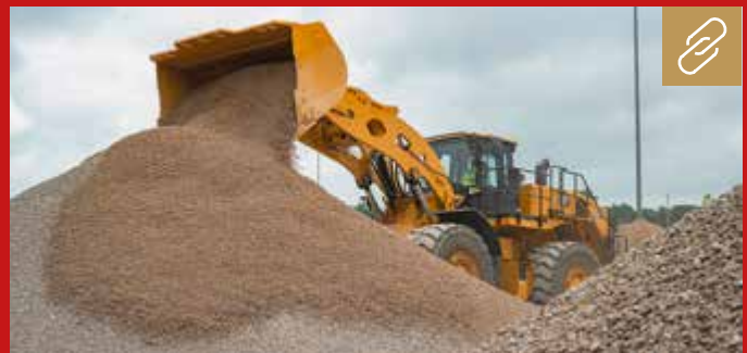
Beim neuen 50-Tonnen-Radlader Cat 988 GC wurden Vorderwagen und Hydraulik überarbeitet, damit eine höhere Nutzlast und Auskipphöhe erzielt werden. Bild: Zeppelin/Cat
