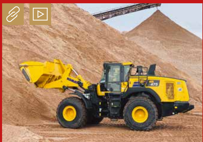
Die unabhängige Hydrauliksteuerung des Radladers WA475-10 ist laut Komatsu einzigartig am Markt und erlaubt kraftvolles und schnelles Laden bei jeder Schaufel. Bild: Komatsu
