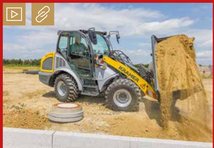
Bei den Kramer-Radladern der 8er Serie bewegen sich die Schaufelkipplasten je nach Modell in einer Spanne von 3.650 bis 4.250 kg. Bild: Modell 8095/Kramer
