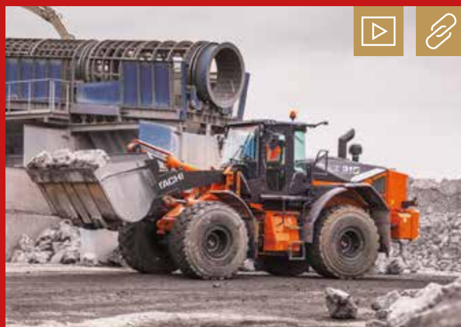
Der Hitachi-Radlader ZW310-7 ist für die schwere Arbeit in Steinbrüchen, im Kieswerk oder im Recycling konzipiert und spielt seine Stärken bei Rückverladung und Beschickung aus. Bild: Kiesel
