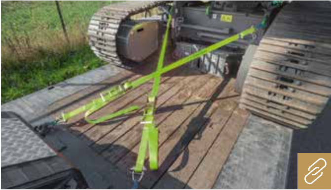
Der Spanset-Schwerlastgurt MaXafe ist ideal zum Quer- und Diagonalzurren von schweren Fahrzeugen und Maschinen. Bild: Spanset
