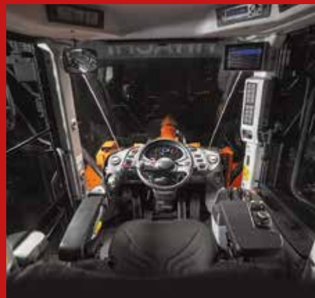
Die Bedienelemente im ZW310-7 sind ergonomisch angeordnet und elektrisch vorgesteuert. Die Hydraulikkonsole ist am luftgefederten Sitz montiert und folgt damit immer der Bewegung des Fahrersitzes. Bild: Hitachi/Kiesel
