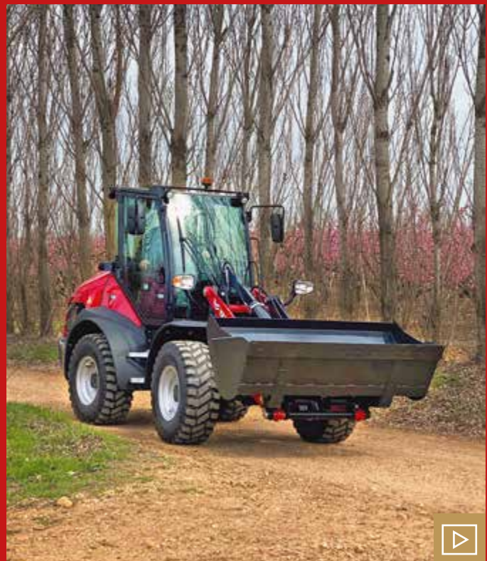
Die allradgetriebenen Radlader V7 und V7 HW fahren eine Höchstgeschwindigkeit von 20 km/h. Optional sind auch 30 km/h möglich. Bild: Yanmar
