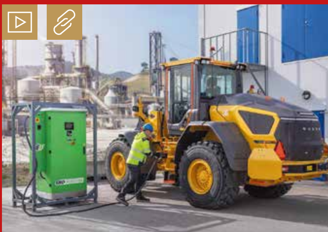
Mit einem 150-kW-Gleichstrom-Schnellladegerät oder dem mobilen Energiespeicher PU500 kann der L90 Electric in etwa 70 Minuten von 0 bis 100 % aufgeladen werden. Bild: Volvo CE
