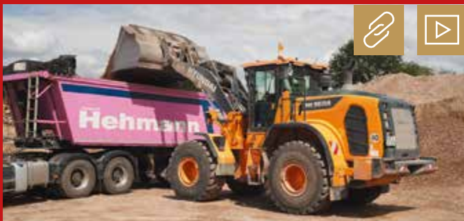
Die HL-A-Radlader-Serie von Hyundai stellt im Leerlauf den Motor ab und spart so Kraftstoff und Emissionen. Die Betriebsart und die Zeit, die der Motor „leer“ läuft, sind einstellbar. Bild: Hyundai CE
