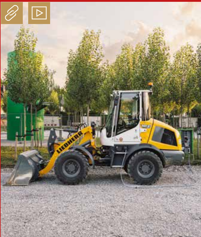
Vollständige Ladevorgänge sind beim L 507 E, abhängig von der On-Board-Ladetechnik und Anschlussleistung, in circa eineinhalb bis drei Stunden möglich. Bild: Liebherr
