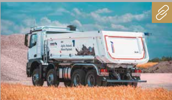
Schmitz Cargobull bietet für den 4-Achs-Motorwagen den passgenauen M.KI Aufbau mit 16 bis 23 m 3 Volumen.
