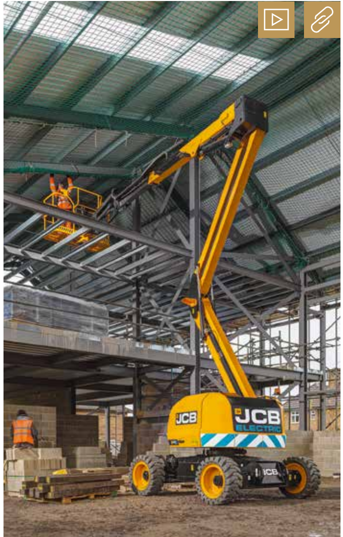
JCB stellt zwei Gelenk-Teleskop-Arbeitsbühnen vor, die wahlweise mit vollem Batterie-Elektro- oder Diesel-Elektro-Hybrid-Antrieb ausgestattet sind. Bild: JCB
