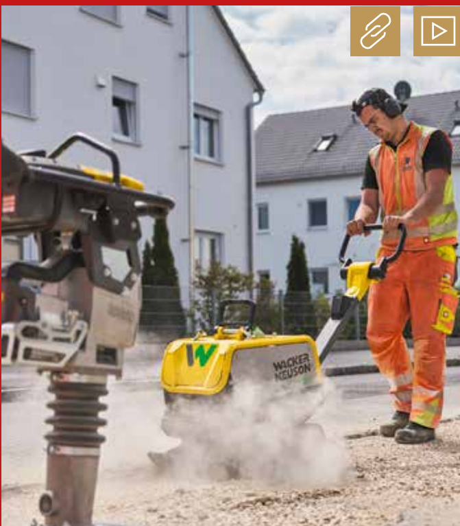
Mit dem emissionsfreien Antrieb und ihrer niedrigen Bauhöhe eignet sich die reversierbare Vibrationsplatte APU3050e von Wacker Neuson insbesondere für den Einsatz im Verbau und im Graben.
