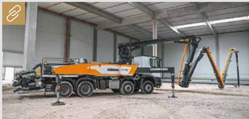
Die besondere Konzeption der 31 XXT Autobetonpumpe macht sich vor allem bei Arbeiten in Gebäuden bemerkbar. Bild: Liebherr
