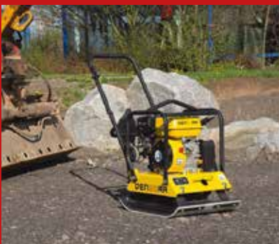
Die drei Rüttelplatten von Denqbar decken Gewichtsklassen von 102 bis 188 kg ab. Bild: Denqbar
