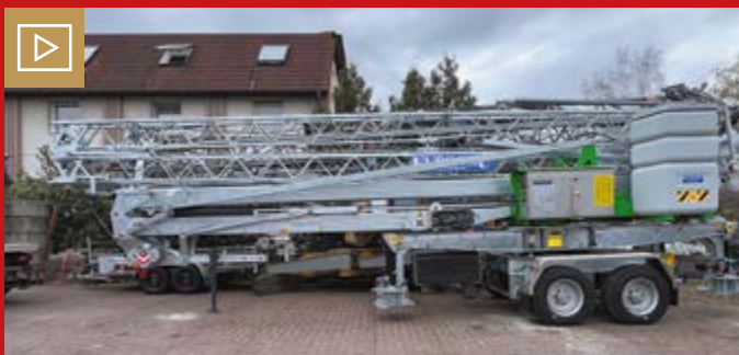
Die EUROSPRINT-Krane werden zunehmend von Bauunternehmern genutzt, da sie als „Feuerwehr-Kran“ einen schnellen und einfachen Ortswechsel ermöglichen. Bild: Eurogru
