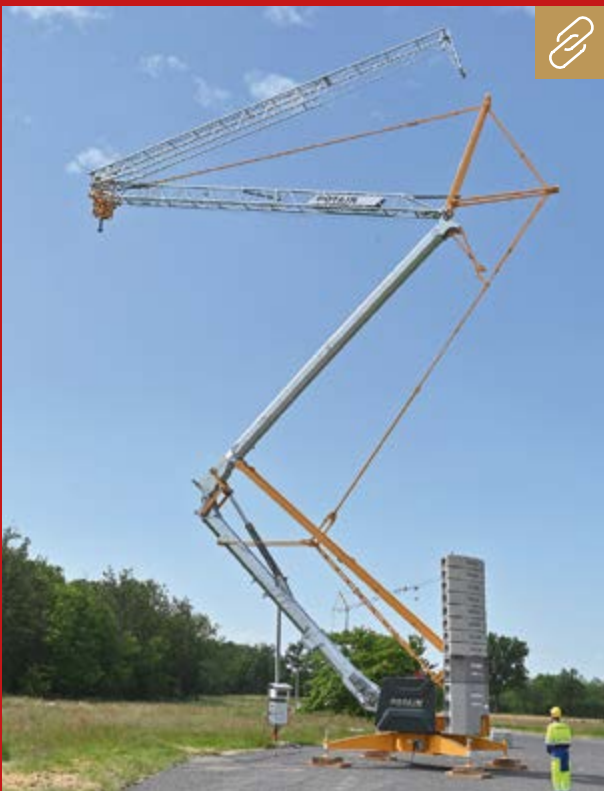
Die zur Serienausstattung gehörende Smart-Set-Up-Technologie sorgt für eine einfachere und sichere Montage und Power Control der Evi-Krane. Bild: Manitowoc
