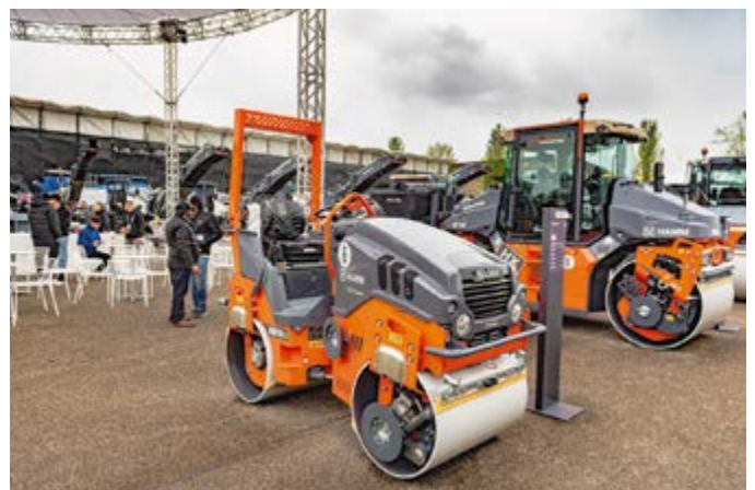
Die 2,5 t schwere, komplett batterie-elektrisch angetriebene Hamm-Walze HD 10e weist die gleiche Verdichtungsleistung auf wie ihr Schwestermodell mit Verbrennungsmotor. Bilder: Paul Deder
