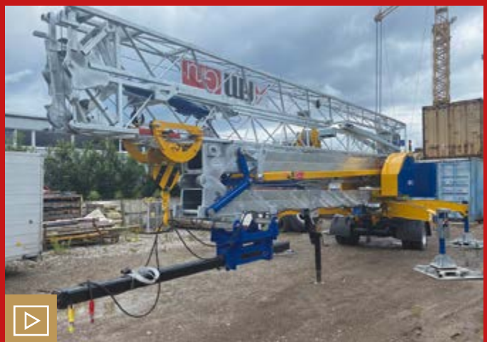
Mit einer Ausladung von 27 m und einer maximalen Tragkraft von 2.400 kg ist der FM GRU 727 RBL-FD von Kaiser Kran gezielt auf die Bedürfnisse von Zimmerern ausgerichtet. Bild: Kaiser Kran
