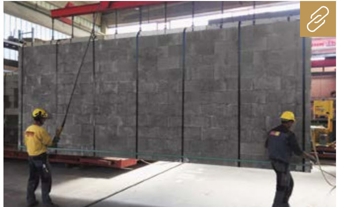
Das Wandtafel-System „KLB-RATIOWALL“ ermöglicht Projektentwicklern und Bauträgern, geschosshohe Außen- und Innenwandtafeln aus Leichtbeton in eigenen Produktionshallen herzustellen. Bild: KLB
