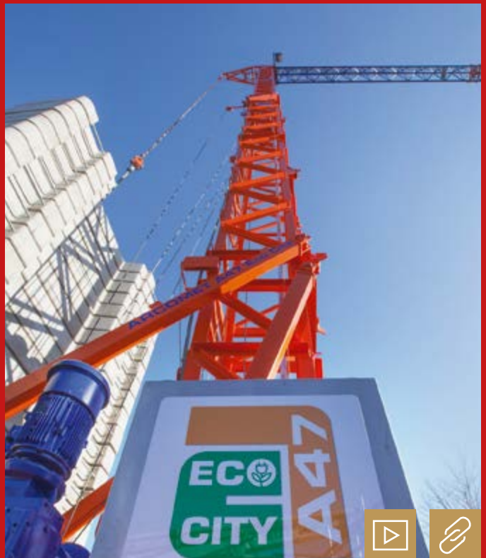
Die Modelle A 47 Eco City, A 45 Eco City und A 40 Eco City eignen sich dank Schwenkradien von lediglich 2,50 m besonders für beengte Baustellen. Bild: Uperio
