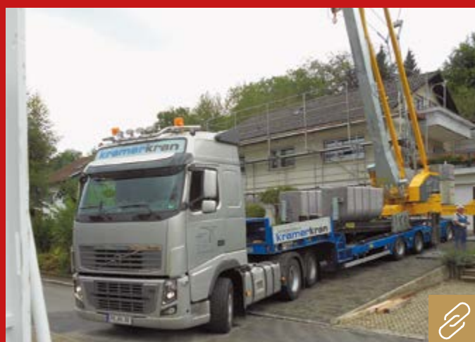
Die KK-Verlegesysteme von Kramer Kran sparen durch die verbesserte Rangierfähigkeit und erleichterte Aufstellung mit Möglichkeiten zum Platzieren, Nivellieren und Changieren Zeit und Geld. Bild: Kramer Kran
