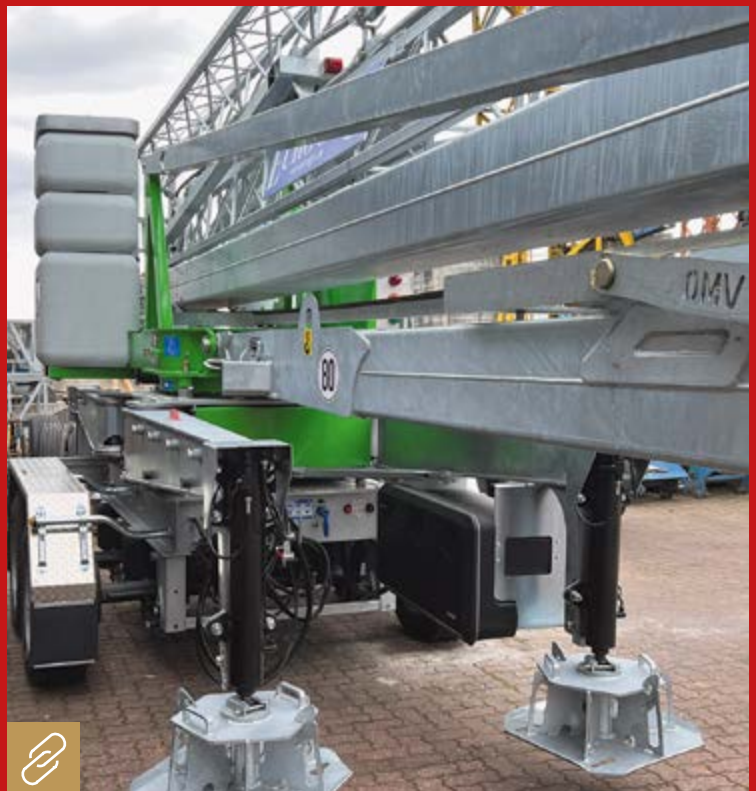
Der neue EUROSPRINT DS.245V bietet durch einen reduzierten Drehradius und die Option einer Rechteckabstützung eine kompaktere Aufstellmöglichkeit. Bild: Eurogru
