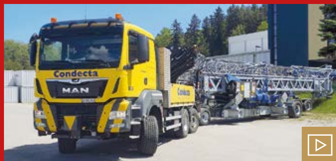
Ihre Kompaktheit erleichtert nicht nur den Transport und den Aufbau der Euro-Krane, sondern macht sie auch sehr manövrierfähig auf Baustellen mit engen Platzverhältnissen. Bild: Conducta
