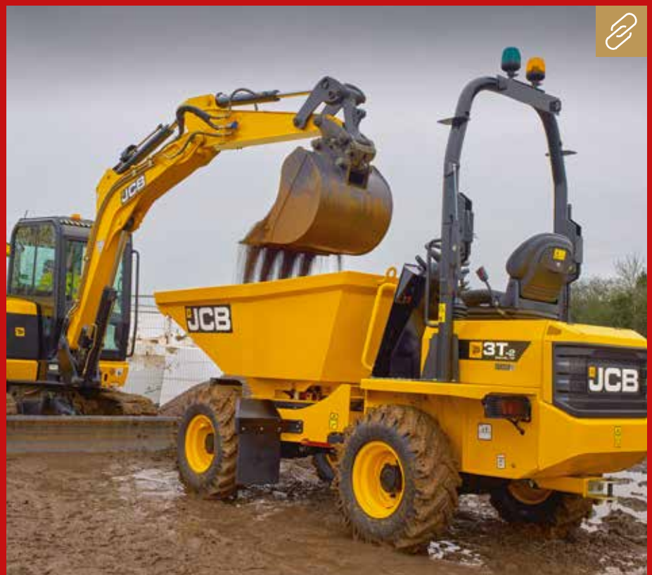
Der JCB 3T-2 ist ein typischer Raddumper für mittelschwere Lasten bis zu 3 t und aufgrund seiner Vielseitigkeit das meistgefragte Modell bei JCB. Bild: JCB
