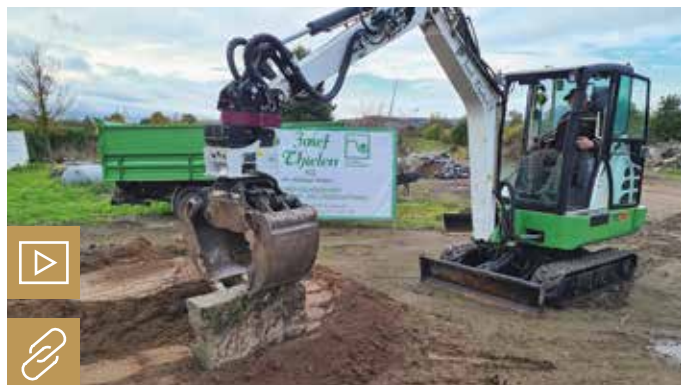
Bei Einsätzen im GaLaBau können Anbaugeräte dank RotoTop flexibel bewegt werden – so wird der Bagger seltener umgesetzt. Bild: Holp
