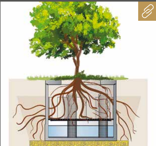
Die neue Baumrigole ViaTree von Mall bietet Bäumen ideale Bedingungen für ausreichende Wasserversorgung. Bild: Mall
