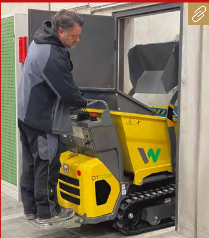
Das neue Mitglied der Zero-Emission-Reihe von Wacker Neuson, der Kettendumper DT05e, eignet sich durch seine kompakten Maße besonders zum Manövrieren und Arbeiten auf engem Raum.
