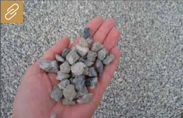
Cemex verstärkt sein Vertua-Angebot mit Recycling-Beton. Im Bild: Rezyklierte Gesteinskörnung aus aufbereitetem Altbeton. Bild: Cemex
