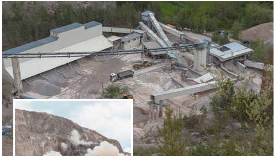
Rund 320.000 t Dolomitgestein pro Jahr werden im Steinbruch Ramsau auf rund 24 ha Fläche abgebaut und zu qualifizierten Zuschlagstoffen für Asphalt und zu Beton verarbeitet. Bilder: Paul Deder
