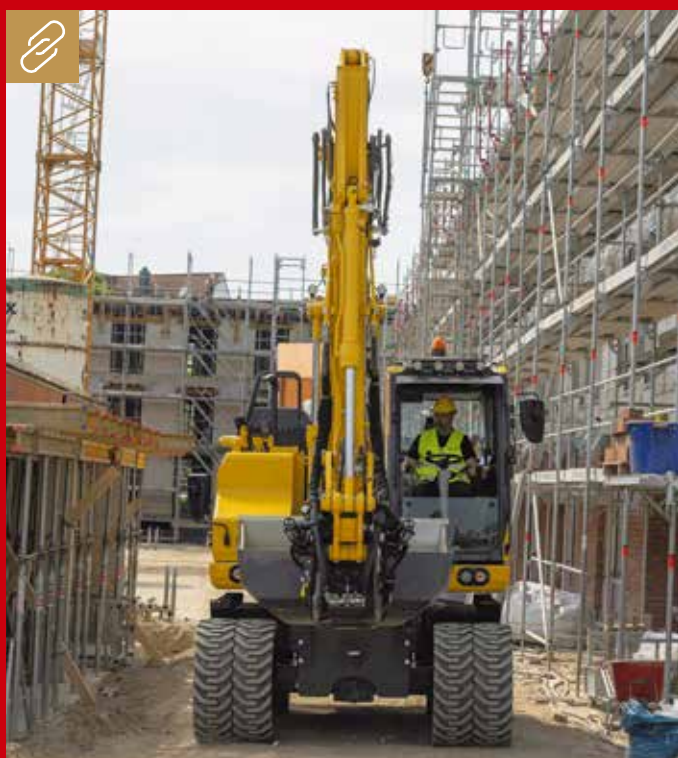
Ausgestattet mit umweltfreundlichem und starkem Komatsu-Stufe-V-konformem Motor ist der PW148-11 20 % stärker als das Vorgängermodell und dabei auch noch sparsamer. Bild: Komatsu
