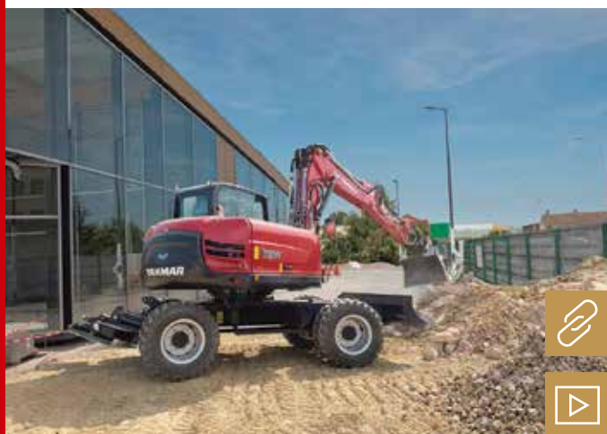
Die spezifische Achsenkonstruktion des B110W mit minimalem Heckausschlag, 13° Pendelwinkel, seitlich eingebautem Motor und niedrigem Schwerpunkt sorgt für eine hohe Stabilität. Bild: Yanmar
