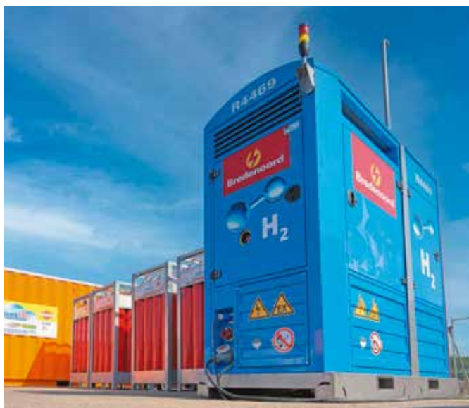
Der Bredenoord Hydrogen Power versorgte sowohl die Baucontainer als auch E-Fahrzeuge und -Maschinen mit emissionsfreiem Strom.
