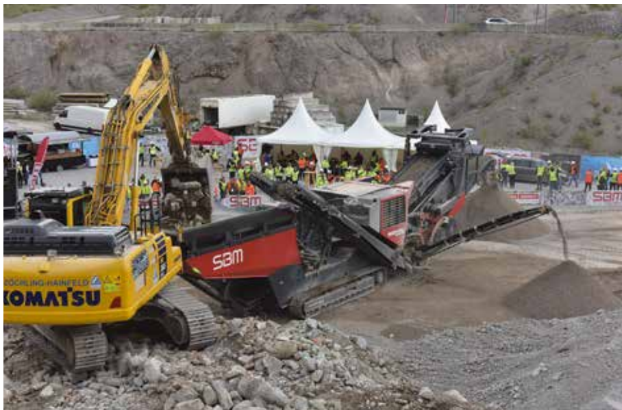
Mit den 600 t/h seines 1400er-Prallbrechers 13/14/4 mit 1.380 × 1.000 mm-Einlauf (B × H) für Aufgabegrößen bis 900 mm definiert der REMAX 600 lt. SBM ein neues Leistungssegment in der mobilen Primär- und Sekundärzerkleinerung. Bild: Paul Deder
