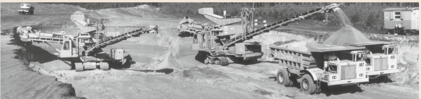
Fast keine Unterbrechung der Förderung gab es, wenn genügend Muldenkipper bereit standen, hier rare IHC „Payhauler“ für 40 t Nutzlast mit Allradantrieb und vorderer Zwillingbereifung. Bild: Archiv
