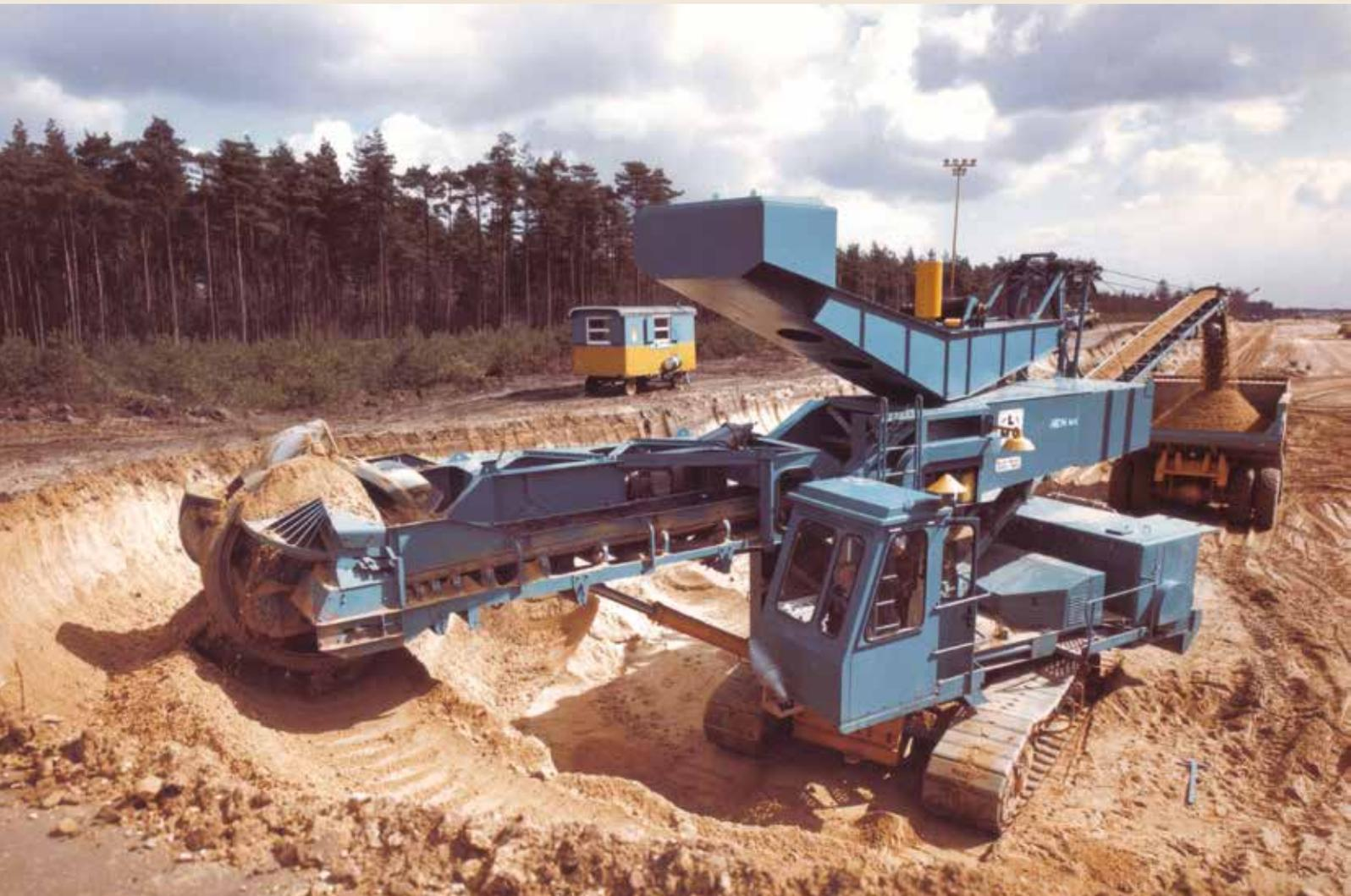
Ein Kleinschaufelradbagger der LMG beim Autobahnbau in den Niederlanden; das lange und daher sehr weit reichende Schwenkförderband erleichterte das flotte Beladen der Muldenkipper. Bild: Archiv
