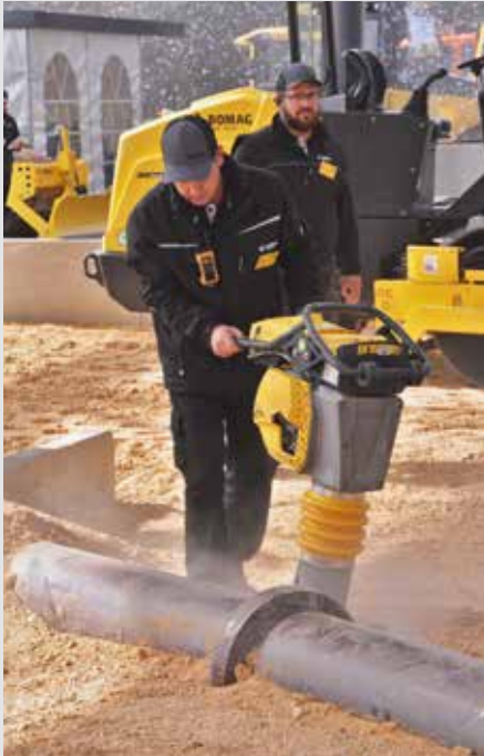
Auch die Kleinsten hatten ihren Auftritt: Der 68-kg-Stampfer BT 65 eignet sich gut für Einsätze im Erd- und Asphaltbau.
