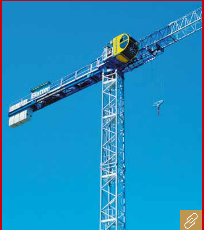
Conducta aus der Schweiz, bekannt für seine Schnellmontagekrane, bietet auch spitzenlose Obendreher wie den Euro SSG 120 für bis zu 60 m Ausladung, 60 m Hakenhöhe und 8 t Höchsttragkraft. Bild: Conducta
