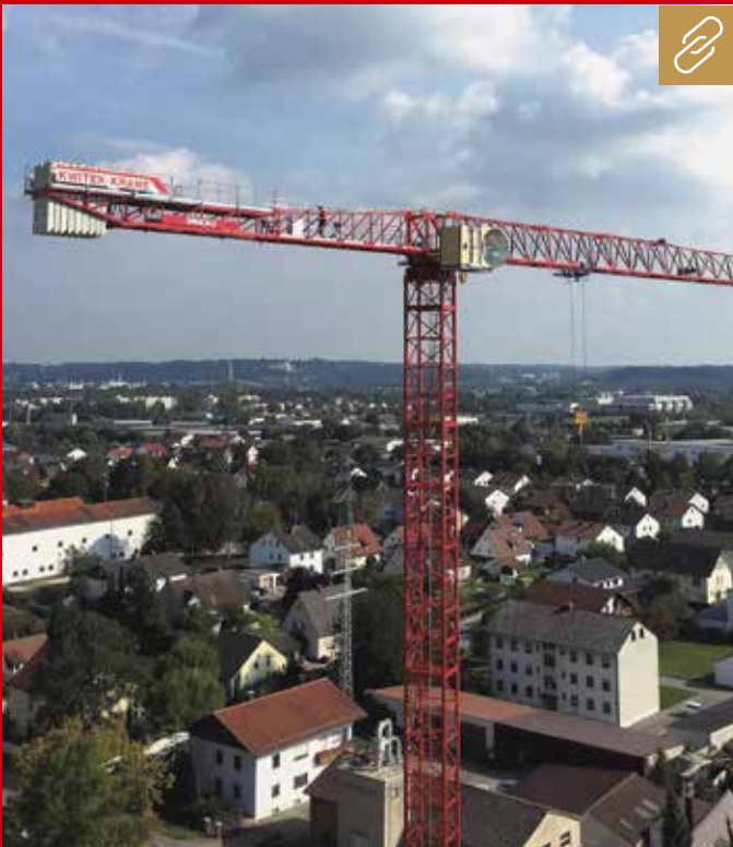
Neu auf dem deutschen Markt sind die Raimondi-Obendreher von Kwitek Krane, hier ein spitzenloser MRT 159 mit bis zu 65 m Ausladung, 47,8 m Hakenhöhe (freistehend) und 10 t maximaler Traglast. Bild: Kwitek Krane
