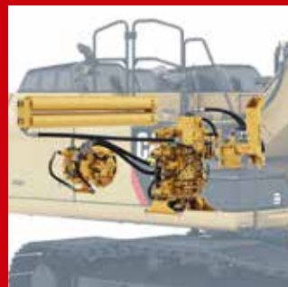
Beim Schwenkwerk des Cat 336F XE gibt es durch das hydraulische Hochdruck-Speichersystem weder elektrische Speicher noch Elektromotoren, sondern einen rein hydraulischen Hybrid-antrieb. Bilder: Zeppelin
