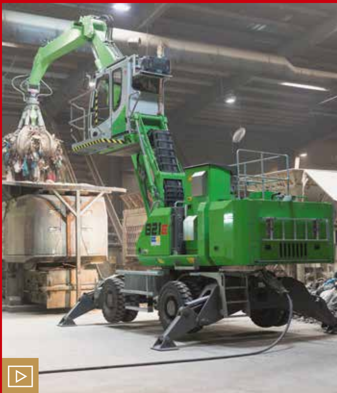
Mobilität und Flexibilität vereint dieser Umschlagbagger 821E Elektro von Sennebogen: Bei stromlosem Dieselbetrieb versorgt ein im Heckballast integriertes Power-Pack den Bagger mit Energie. Bild: Sennebogen
