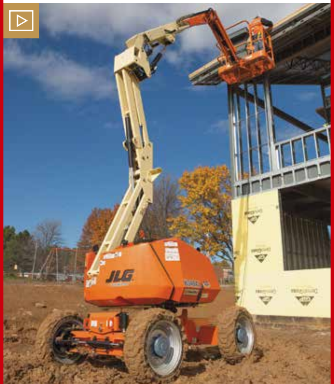
Sowohl rein elektrisch als auch im Dieselmotorbetrieb kann die H340AJ von JLG arbeiten, die weltweit erste Hybrid-Teleskoparbeitsbühne. Acht Bordbatterien werden im Dieselmotorbetrieb rasch aufgeladen. Bild: JLG
