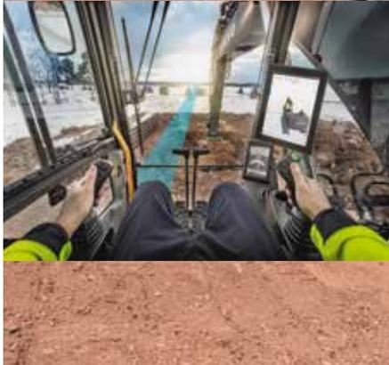
Immer mehr Assistenzsysteme kommen auf dem Markt, um dem Fahrer unter die Arme zu greifen und so die Produktivität bei der Arbeit zu erhöhen. Genau hier setzt der Dig Assist von Volvo Construction Equipment an. Das System – erhältlich als 2D- oder In-Field-Variante – ermöglicht es dem Maschinenführer, Baggerarbeiten mit noch höherer Präzision und in kürzerer Zeit auszuführen. **17**
