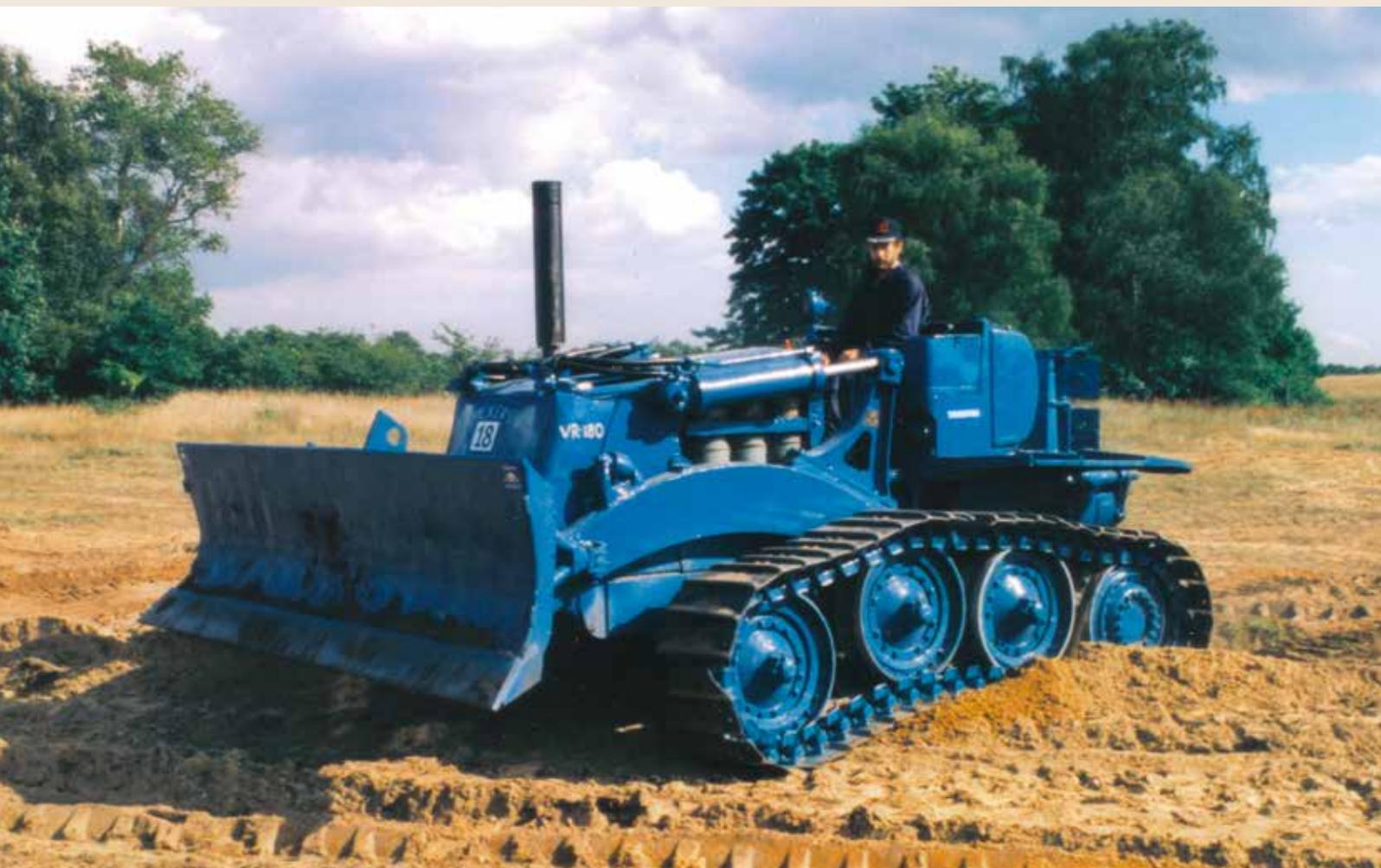
Vickers VR-180, hier schon mit hydraulischer Schildbetätigung und dem bemerkenswert gelagerten Laufwerk, das keine Fahrschwingungen auf den Planierschild übertrug.
